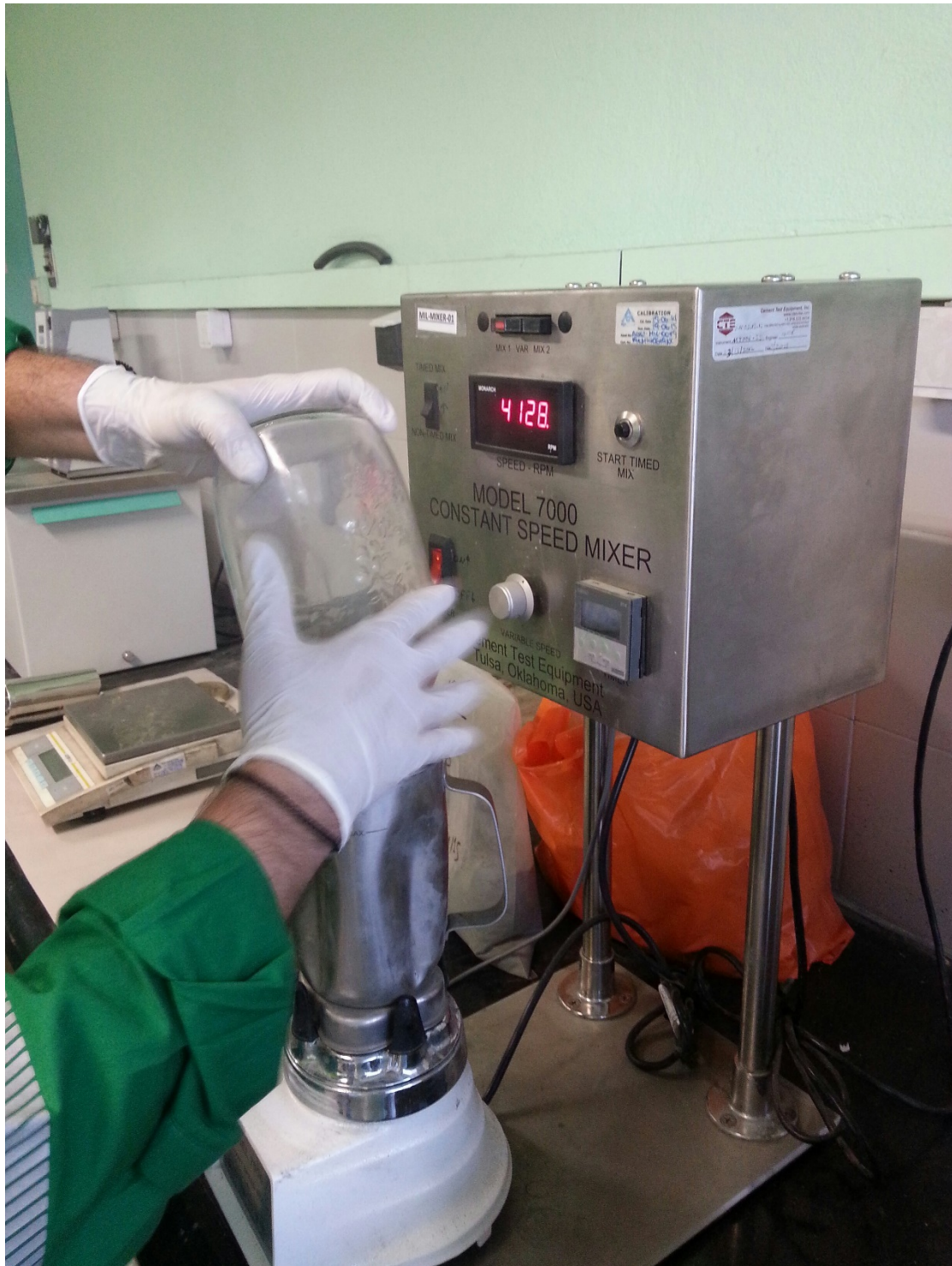
Εικόνα 4: Αναδευτήρας πιστοποιημένος για τη διεξαγωγή μετρήσεων σύμφωνα με τα πρότυπα API.
