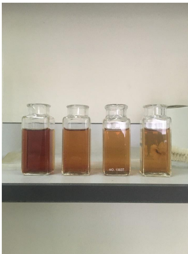
Εικόνα 4.4 Μέτρηση \text{NO}_3^- (σκουρότερο χρώμα σημαίνει υψηλότερη συγκέντρωση)
