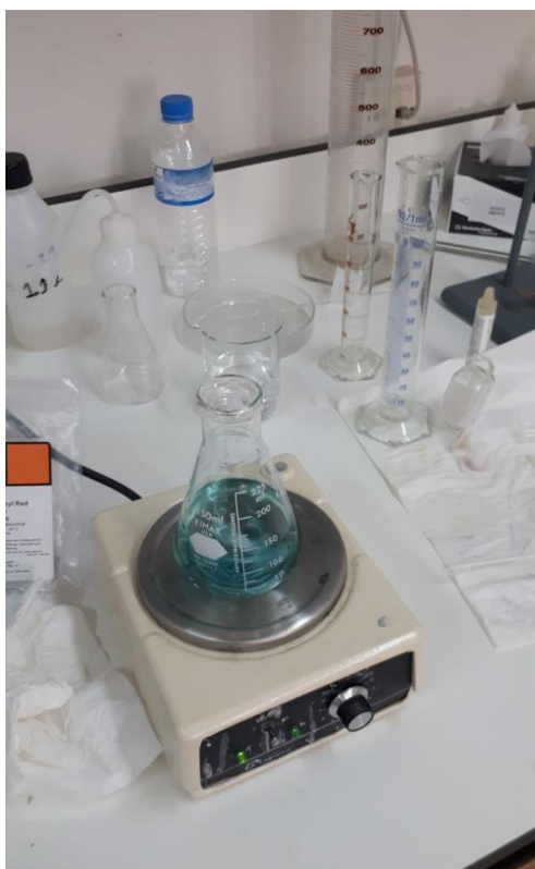
Εικόνα 4.5 Διαδικασία μετρήσεων \text{Cl}^- , \text{HCO}_3^- , \text{Ca}^{++} , \text{Mg}^{++}
