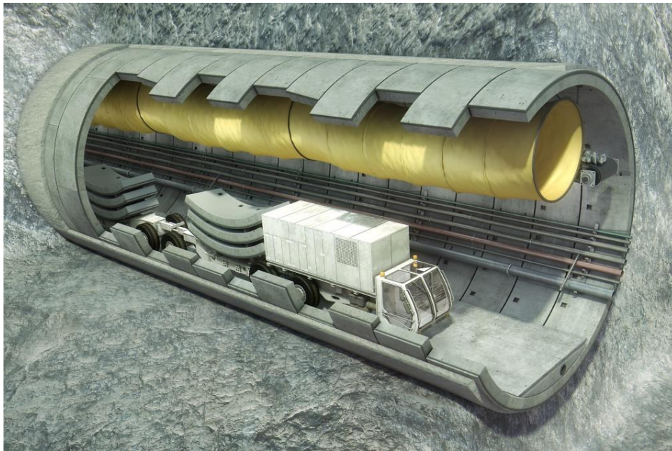
Εικόνα 3 5. Επένδυση σήραγγας με προκατασκευασμένα στοιχεία - segments (Πηγή: AGJV).
