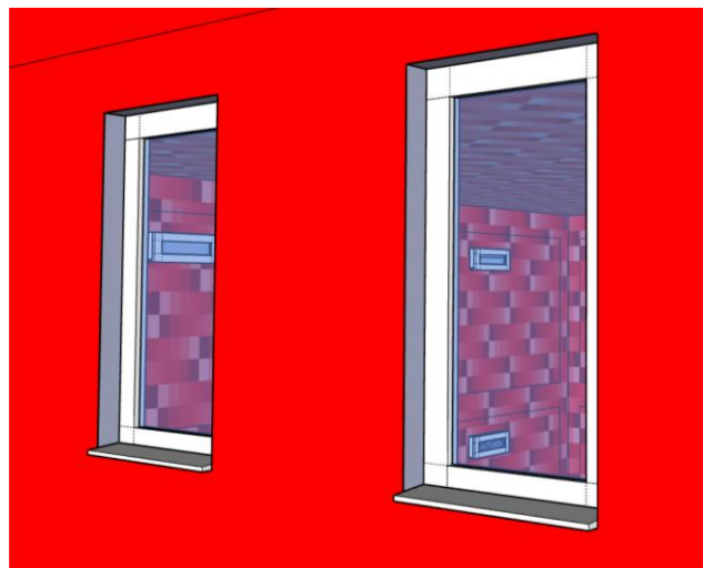
Εικόνα 4.51: Η εσοχή του παραθύρου όπως σχεδιάζεται μέσω του σχεδιαστικού προγράμματος DesignPH
