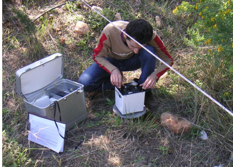
Φωτογραφία 3.2: Διεξαγωγή βαρυτικής μετρήσεως στη περιοχή ενδιαφέροντος.
