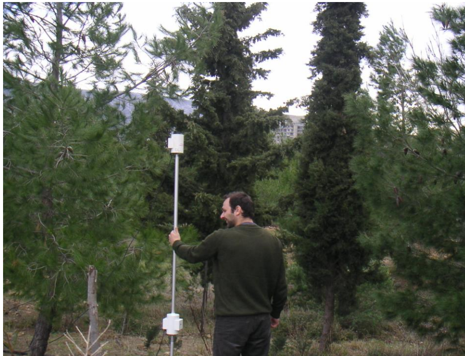
Φωτογραφία 3.3: Λήψη μαγνητικών μετρήσεων με τη μέθοδο της διαφορικής μαγνητομέτρησης στο ύπαιθρο.
