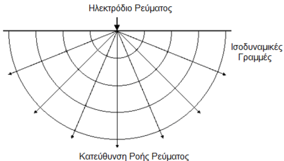
Εικόνα I.1 : Διάδοση του ρεύματος και κατανομή των δυναμικών γραμμών λόγω σημειακής πηγής σε ομογενή ημιχώρο.
