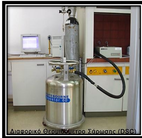
Εικόνα 40: Μελέτη νανοϊνών με την τεχνική της Διαφορικής Θερμιδομετρίας Σάρωσης
