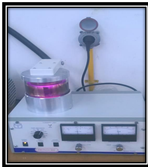
Εικόνα 35: Επιχρύσωση δειγμάτων για μετέπειτα μέλετη αυτών στη συσκευή SEM
