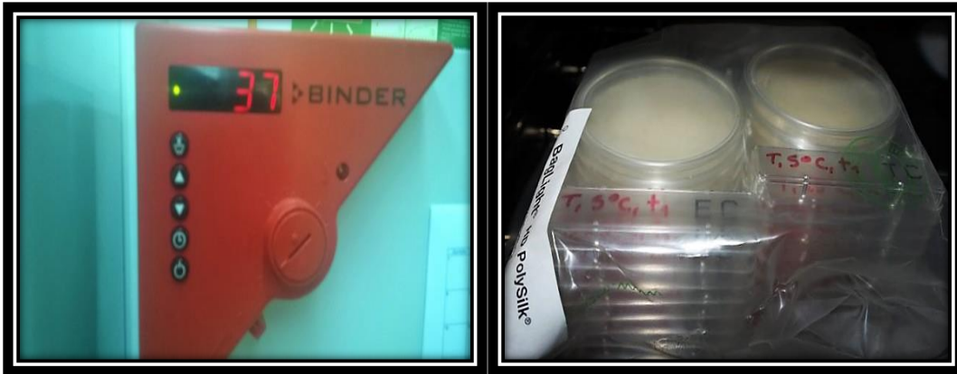
Εικόνα 45: Επώαση των τρυβλίων με το υπόστρωμα για ανάπτυξη E.coli και APC στους 37 °C
