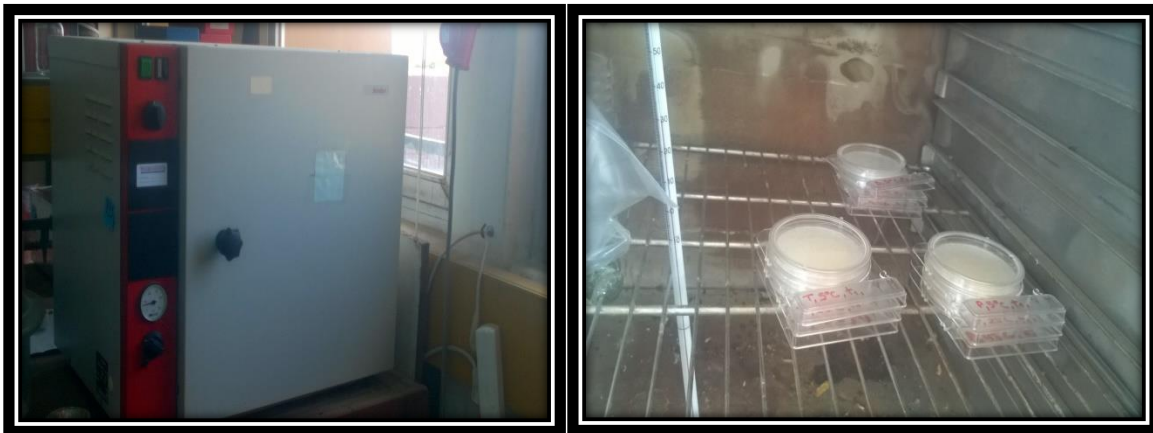
Εικόνα 46: Επώαση των τρυβλίων με το υπόστρωμα για ανάπτυξη Yeasts/ Moulds στους 30 °C
