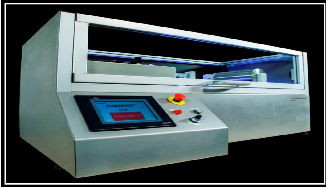
Εικόνα 30: Συσκευή Ομοαξονικής Ηλεκτροστατικής Ινοποίησης - FLUIDNATEK LE-10, BioInicia [114]
