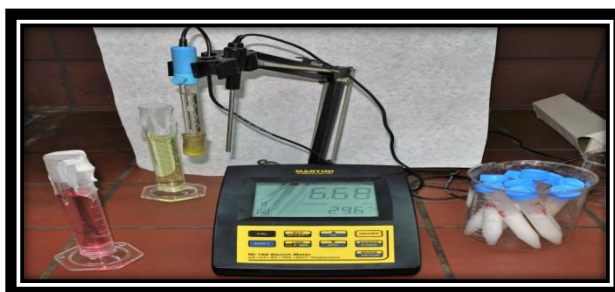
Εικόνα 48: Μέτρηση του pH των δειγμάτων κρέμας
