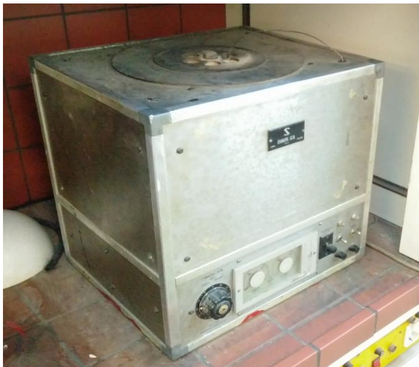
Εικόνα 4:Θερμοστατούμενο μπλοκ για ανθρακούχο υπόλειμμα κατά Ramsbottom
