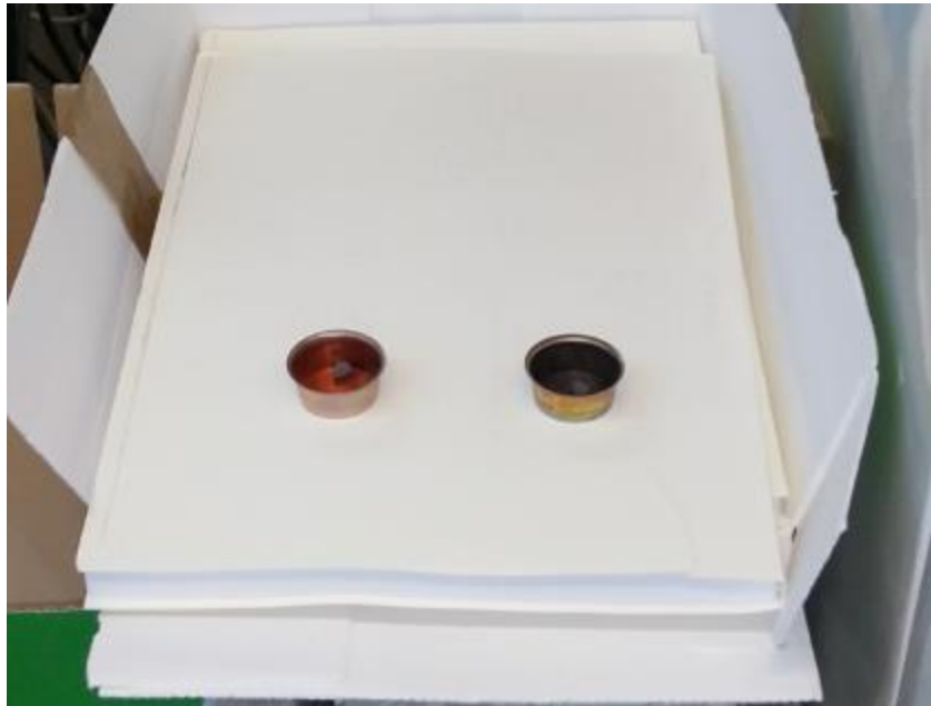
Εικόνα 3:Υποδοχείς δείγματος D7344 πριν και μετά τη χρήση
