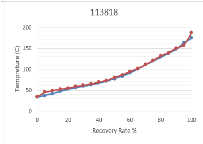
Διάγραμμα Σ-17: Καμπύλες απόσταξης ENISO3405 και D7344 δείγμα 113818
