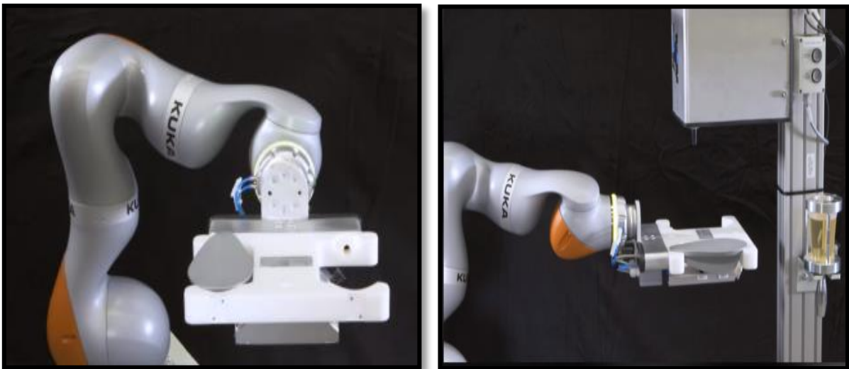
Εικόνα 2. (Αριστερά) Ο εργαζόμενος τοποθετεί το κομμάτι εργασίας στη λαβή ρομπότ LBR IIWA και Εικόνα 3. (Δεξιά) Το ρομπότ LBR IIWA μετακινεί το κομμάτι εργασίας προς το ακροφύσιο, από το οποίο θα εξαχθεί η κολλητική ουσία
