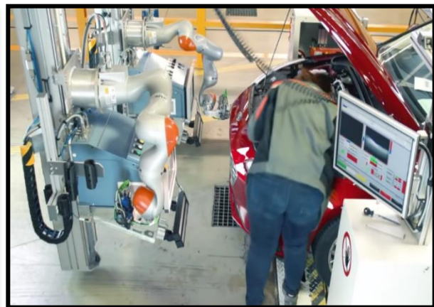
Εικόνα 8. (Αριστερά) Το ρομπότ ανιχνεύει και στη συνέχεια βιδώνει την υπάρχουσα βίδα
