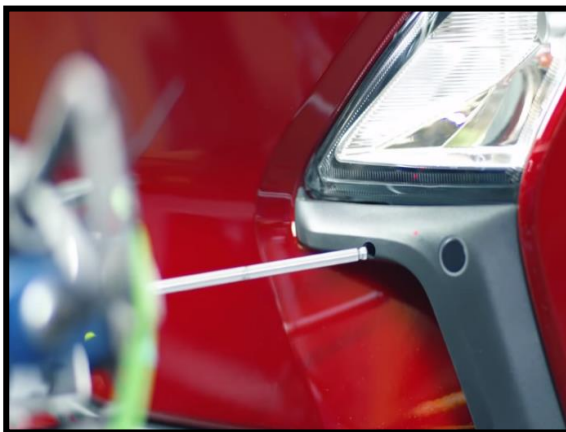
Εικόνα 8. (Αριστερά) Το ρομπότ ανιχνεύει και στη συνέχεια βιδώνει την υπάρχουσα βίδα
