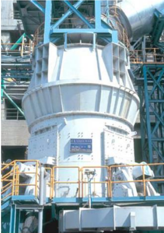
Εικόνα 5.4 Κατακόρυφος μύλος άλεσης τσιμέντου εργοστασίου Καμαρίου [39]
