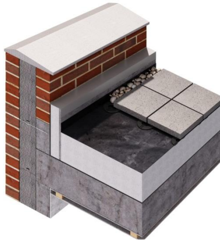
Εικόνα 2-10 Εφαρμογή πλακών διογκωμένης πολυστερίνης EPS(με λευκό χρώμα) σε δάπεδο[57]
