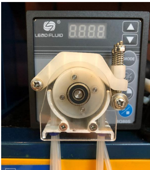
Εικόνα 6.2: Περισταλτικές αντλίες μικρο-ροής μεταβλητής ταχύτητας και τριών καναλιών που χρησιμοποιήθηκαν στα πειράματα δυναμικής ρόφησης.
