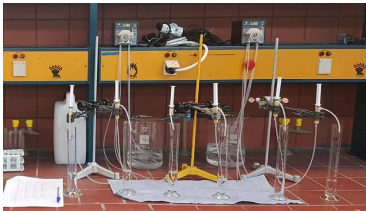
Figure 38: Εργαστηριακή διάταξη των στηλών από σύριγγες (αρχείο συγγραφέα).
