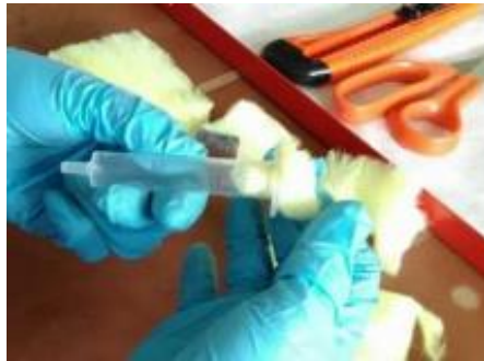
Figure 3 Τοποθέτηση και συμπίεση του υαλοβάμβακα.
