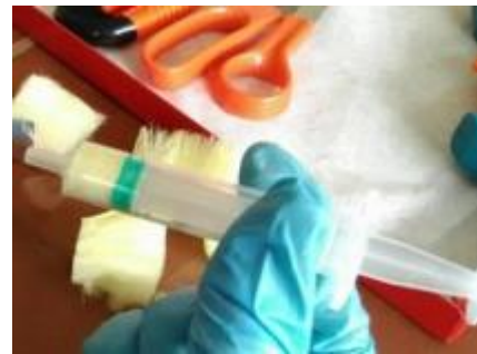
Figure 3 Τοποθέτηση και συμπίεση του υαλοβάμβακα.
