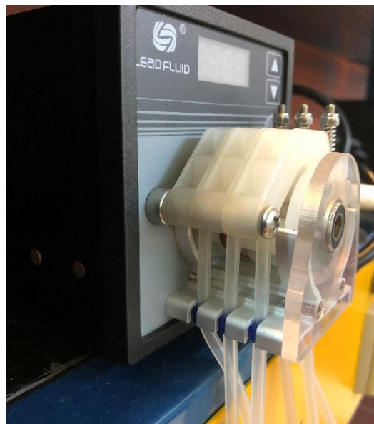
Εικόνα 6.2: Περισταλτικές αντλίες μικρο-ροής μεταβλητής ταχύτητας και τριών καναλιών που χρησιμοποιήθηκαν στα πειράματα δυναμικής ρόφησης.
