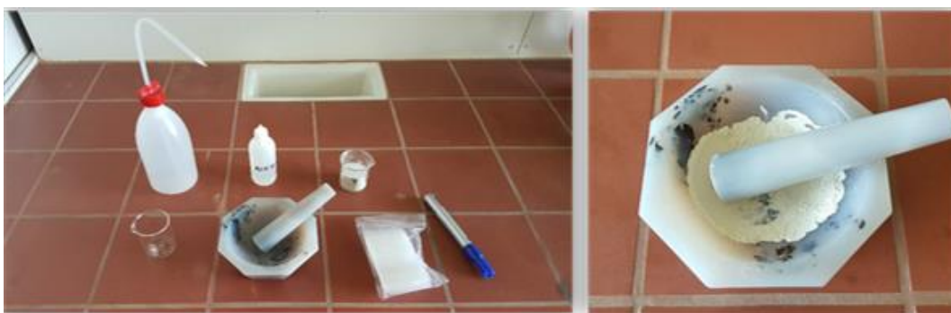
Εικόνα 5.6: Κονιοποίηση των ορυκτών (αρχείο συγγραφέα).
