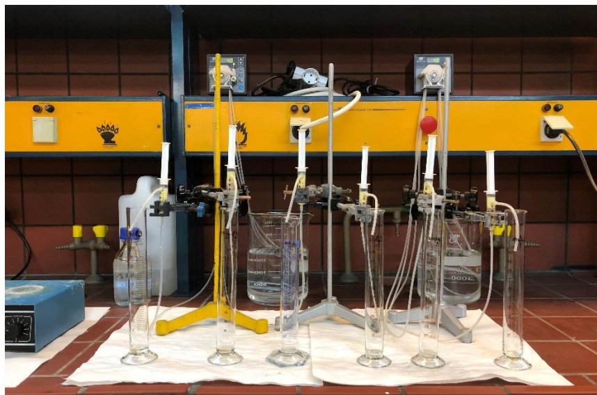
Εικόνα 6.1: Εργαστηριακή διάταξη των πειραμάτων δυναμικής ρόφησης χρησιμοποιώντας σύριγγες των 5 mL.
