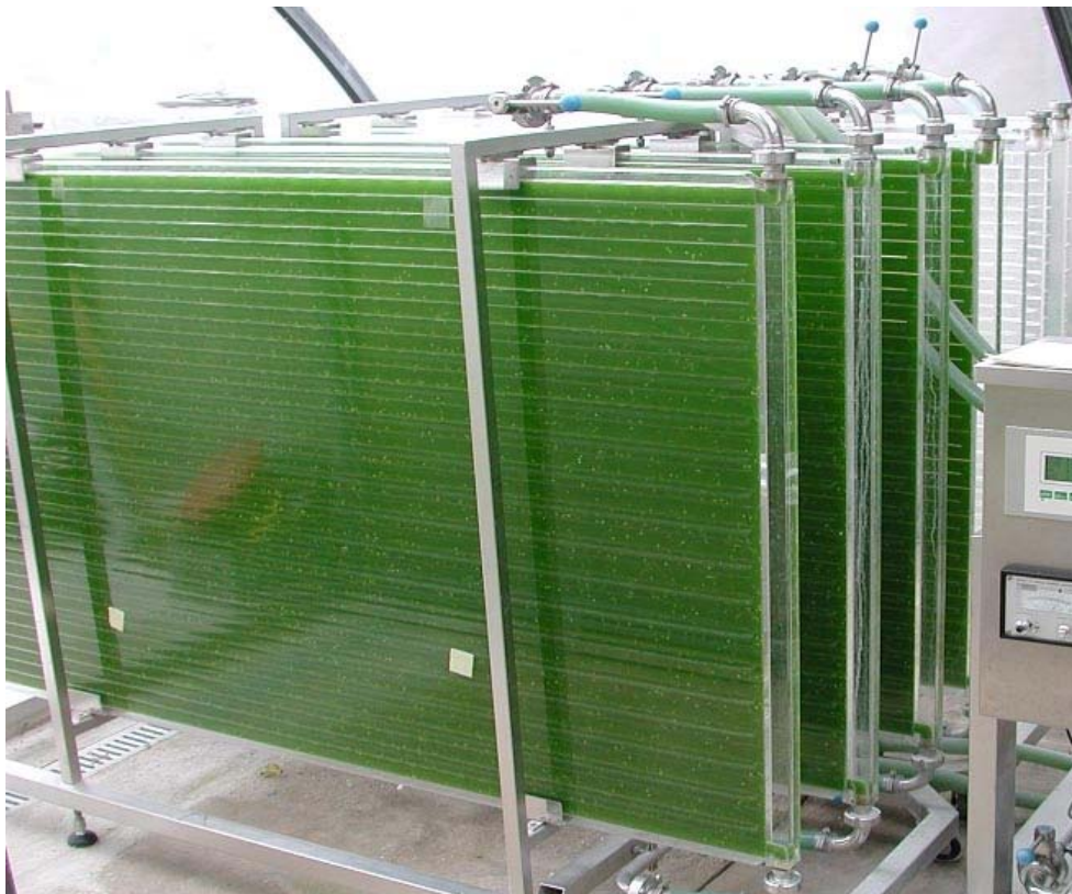
Εικόνα 2.3 Φωτοβιοαντιδραστήρας τύπου πλάκας (πηγή:IGV Biotech)
