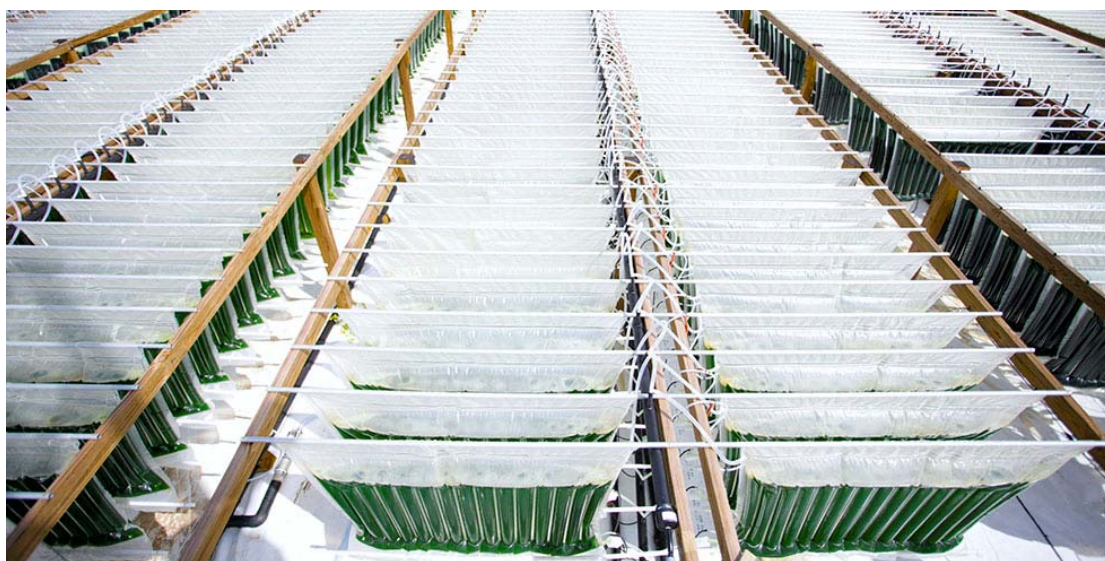
Εικόνα 2.5 Φωτοβιοαντιδραστήρας τύπου φύλλου (πηγή: IGV Biotech)
