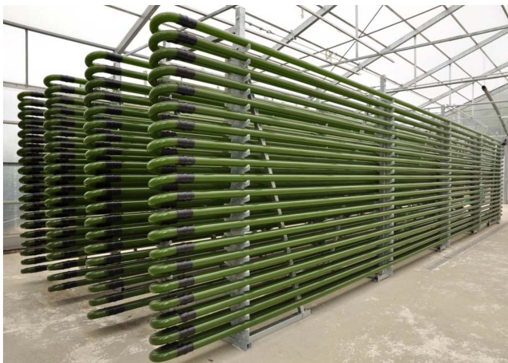
Εικόνα 2.1 Σωληνοειδής φωτοβιοαντιδραστήρας (πηγή:IGV Biotech)
