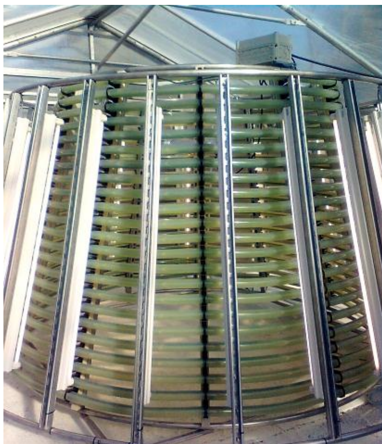
Εικόνα 2.2 Christmas tree φωτοβιοαντιδραστήρας (πηγή:IGV Biotech)
