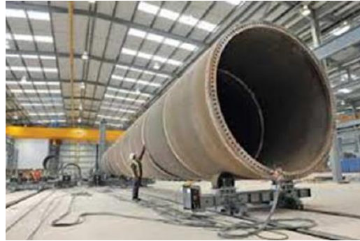
Εικόνα 1-40: Συγκόλληση επιμέρους καμπυλωμένων ελασμάτων χάλυβα και δημιουργία επιμέρους τμημάτων για μεταφορά στο εργοτάξιο [1-15]
