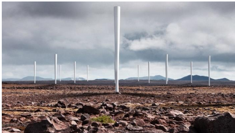
Εικόνα 1-31: Πειραματική ανεμογεννήτρια χωρίς πτερύγια από την Ισπανική εταιρεία Vortex (2010) [1-10]
