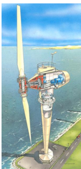
Εικόνα 1-26: Ανεμογεννήτρια Newecs-45 στην Ολλανδία (1985) (ρότορας διαμ. 45m, ισχύς 1MW) [1-6]
