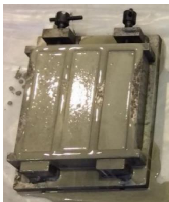
Εικόνα 3-3: Πρισματικά δοκίμια κονιάματος για προσδιορισμό μηχανικών χαρακτηριστικών [3-3]
