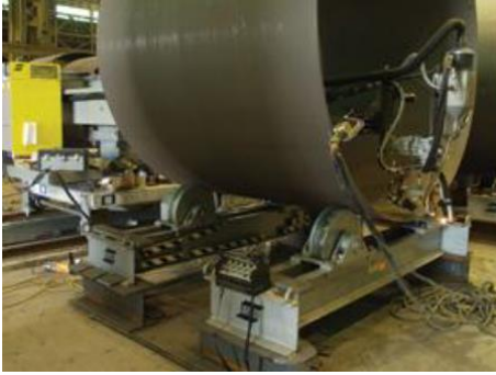
Εικόνα 1-40: Συγκόλληση επιμέρους καμπυλωμένων ελασμάτων χάλυβα και δημιουργία επιμέρους τμημάτων για μεταφορά στο εργοτάξιο [1-15]
