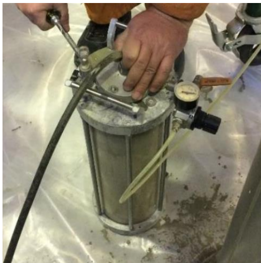
Εικόνα 3-1: Αντλία κενού για υδραυλική χρήση [3-3]
