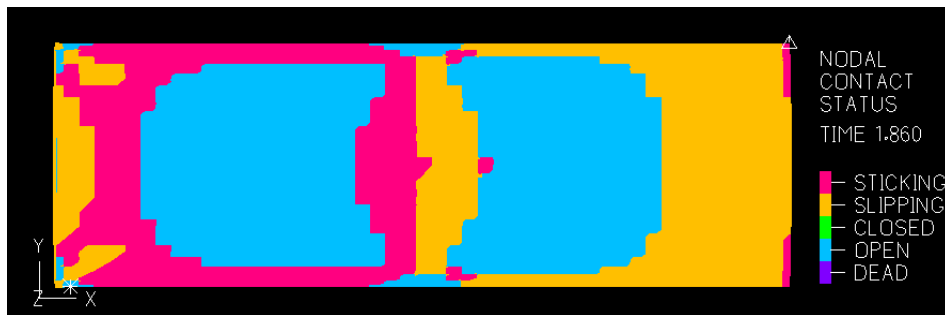
Σχήμα 4-43: Πυρήνας από κονίαμα. Σημείο C: Παραμόρφωση, τάση Mises, αριθμός ρωγμών, κατάσταση στοιχείων επαφής. Όψη XY, άνω τμήμα.
