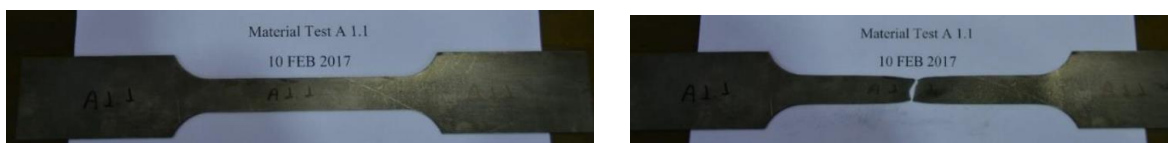
Εικόνα 3-14: Μορφή δοκιμίου χάλυβα πριν και μετά τη δοκιμή μονοαξονικού εφελκυσμού [3-3]
