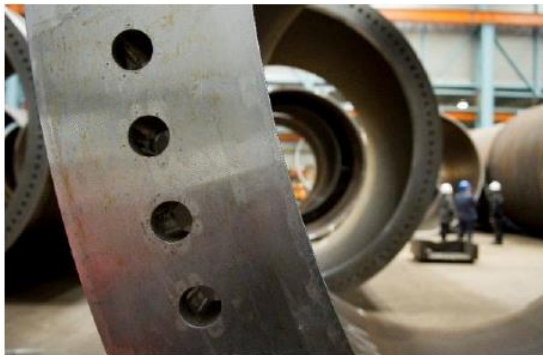
Εικόνα 1-43: Δακτύλιοι (φλάντζες) σε κάθε άκρο των επιμέρους τμημάτων [1-15]
