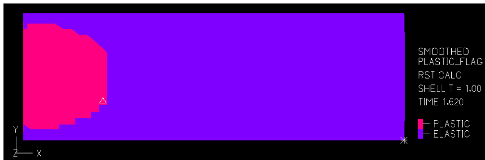
Σχήμα 4-31: Εξωτερικό χαλύβδινο έλασμα. Σημείο Β: Παραμόρφωση, τάση Mises, μέγεθος πλαστικής παραμόρφωσης. Όψη XY, άνω τμήμα.
