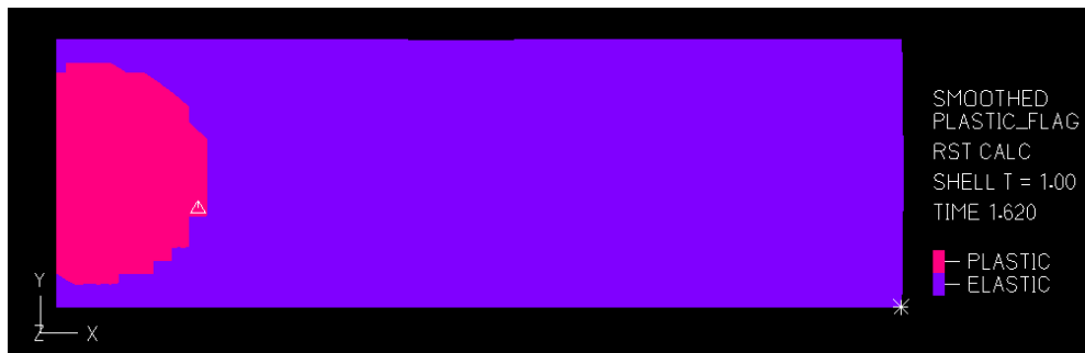
Σχήμα 4-28: Εσωτερικό χαλύβδινο έλασμα. Σημείο Β: Παραμόρφωση, τάση Mises, μέγεθος πλαστικής παραμόρφωσης. Όψη XY, άνω τμήμα.
