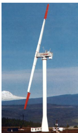
Εικόνα 1-19: MOD-2 (ρότορας διαμ. 91.4, ισχύς 2.5MW) (1977) [[1-6]
