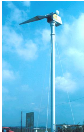
Εικόνα 1-23: Ανεμογεννήτρια από το πρόγραμμα Μοπορτερος και τη Γερμανική εταιρεία Mbb (1980) (ρότορες 12.5m-51m, ισχύς 25kW-1000kW) [1-6]
