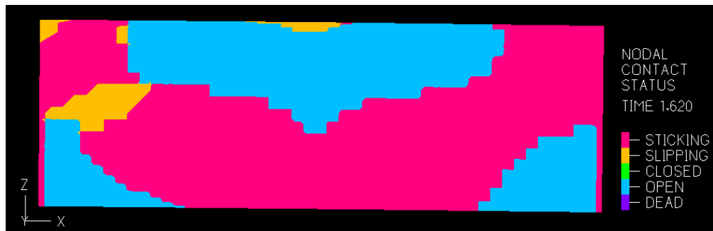
Σχήμα 4-36: Πυρήνας από κονίαμα. Σημείο Β: Παραμόρφωση, τάση Mises, αριθμός ρωγμών, κατάσταση στοιχείων επαφής. Όψη XZ.
