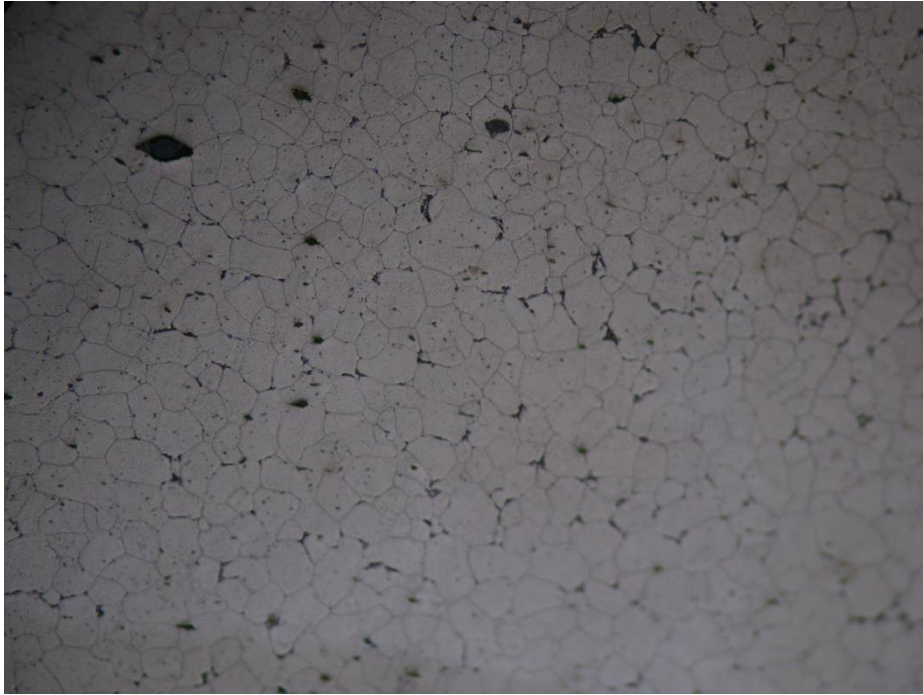
Εικόνα 3.4 Μικρογραφία οπτικού μικροσκοπίου Δοκιμίου 4 Ήμισυ μεταλλικού συνδέσμου διπλού «Ταυ», από συμπλήρωμα κιονόκρανου κατά την αναστηλωτική επέμβαση Μπαλάνου
