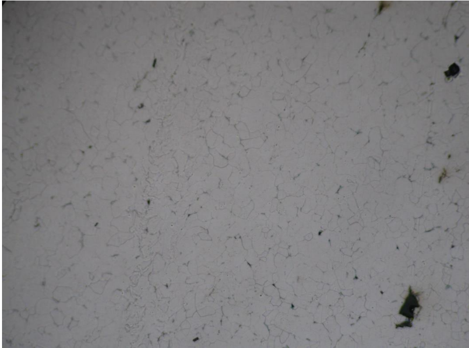
Εικόνα 3.1 Μικρογραφία οπτικού μικροσκοπίου Δοκιμίου Νο 1 μεταλλικός Γόμφος ρωμαϊκής εποχής
