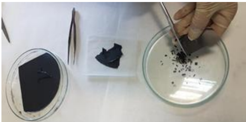
Εικόνα 2-14 Τεμαχισμός φύλλων του οξειδίου του γραφενίου.
