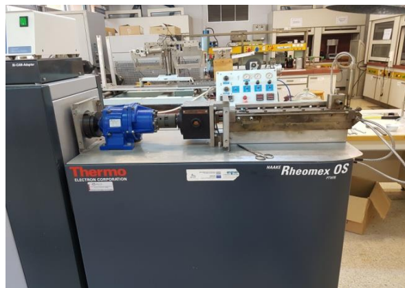
Εικόνα 2-2: Δικόχλιο σύστημα εκβολής Haake PTW 16.
