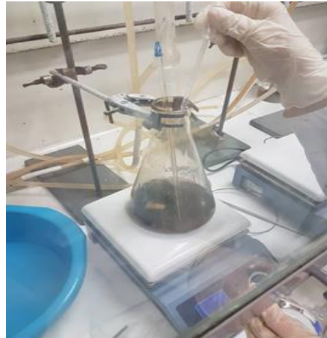
Εικόνα 2-8 Προσθήκη νερού και ανάδευση διαλύματος στους 95 °C για μία ώρα.
