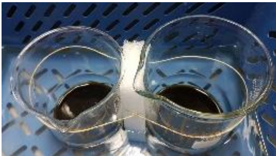
Εικόνα 2-16 Υδατικό διάλυμα GO/PEG σε λουτρό υπερήχων.
