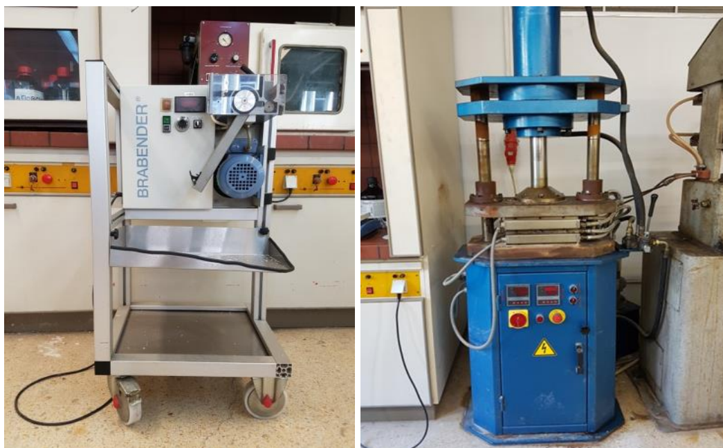
Εικόνα 2-5 Συσκευή τεμαχισμού εκβαλλόμενου προϊόντος(αριστερά) Υδραυλική πρέσα (δεξιά).
