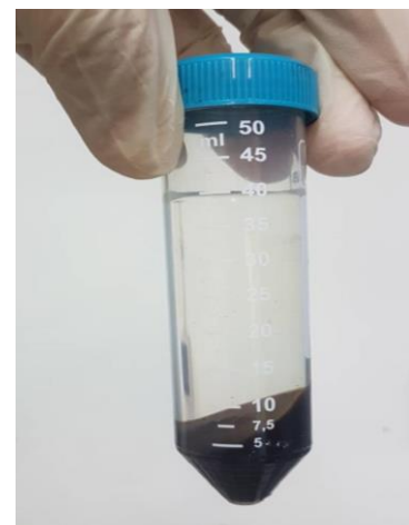
Εικόνα 2-11 Προϊόν καθίζησης έπειτα από επαναλαμβανόμενες φυγοκεντρίσεις.
