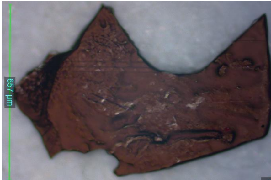
Σχήμα 3.6 Μονοκρύσταλλος YBa_2Cu_3O_7 του οποίου οι μετρήσεις αναλύθηκαν σ' αυτή τη διπλωματική.
