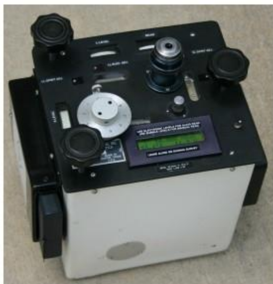
Εικόνα 42 : Βαρυτόμετρο Lacoste Romberg G580, με το οποίο έγιναν και οι μετρήσεις.
