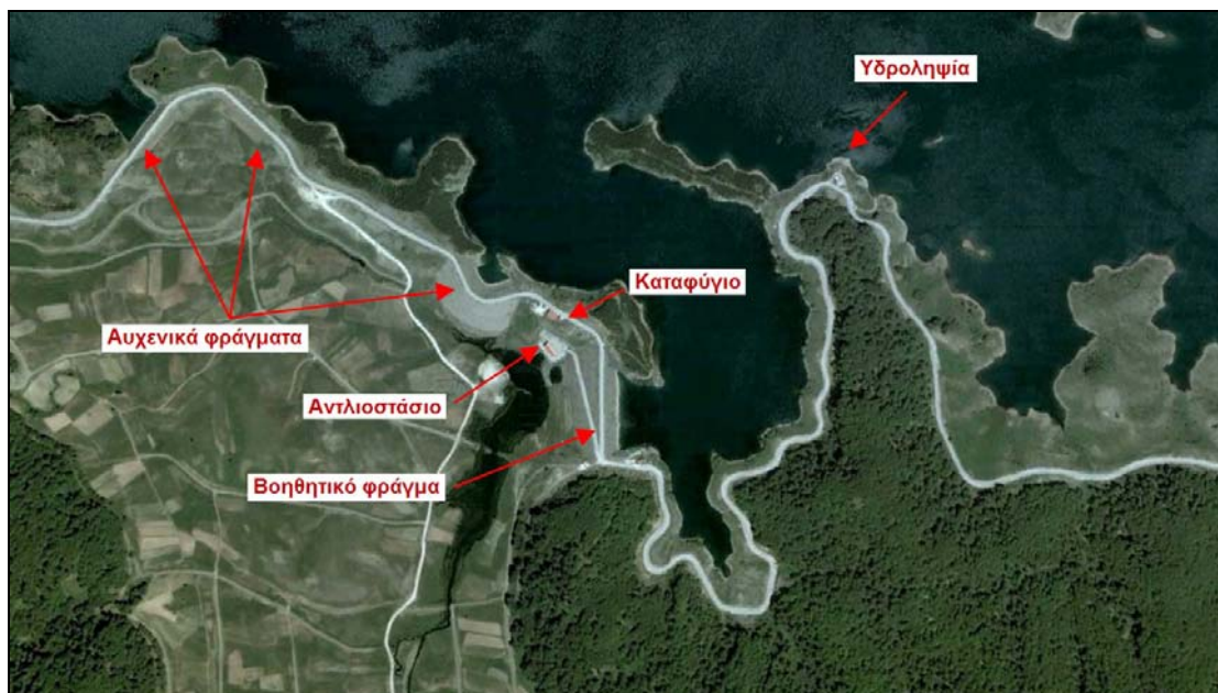
Εικόνα 4: Η περιοχή εγκαταστάσεων 1 με τα τρία αυχενικά φράγματα, το βοηθητικό φράγμα, την υδροληψία και το αντλιοστάσιο Πολιτών
