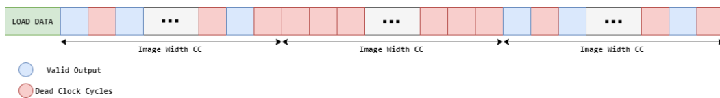
Σχήμα 13: Υπο-χρησιμοποίηση της μονάδας για ένα κανάλι εισόδου. Τα κόκκινα τετράγωνα υποδηλώνουν άκυρες στοίβες ενώ τα μπλέ τις έγκυρες.
