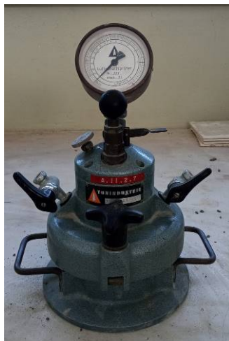
Εικόνα 4.6: Συσκευή μέτρησης περιεκτικότητας αέρα νωπού κονιάματος
