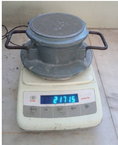
Εικόνα 4.7: Μέτρηση μοναδιαίου βάρους
