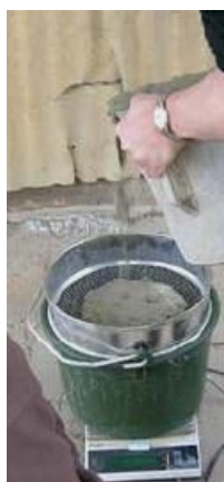
Εικόνα 2.12: Δοκιμή σταθερότητας μέσω κοσκίνησης (Διαμαντώνης, 2008)
