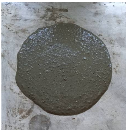
Εικόνα 5.4: Εξάπλωση μίγματος σύνθεσης PUM
