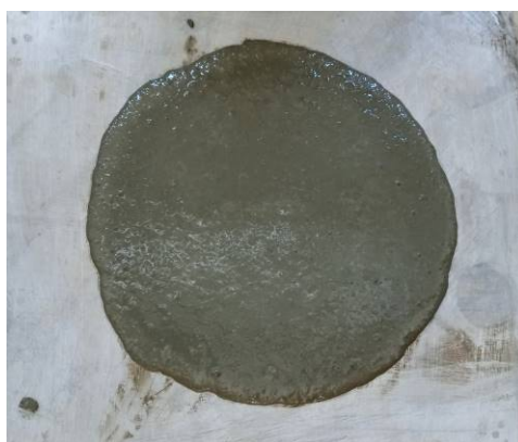
Εικόνα 5.5: Εξάπλωση μίγματος σύνθεσης NOF
