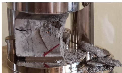
Εικόνα 5.7: Δοκίμιο μετά τη δοκιμή θλίψης
