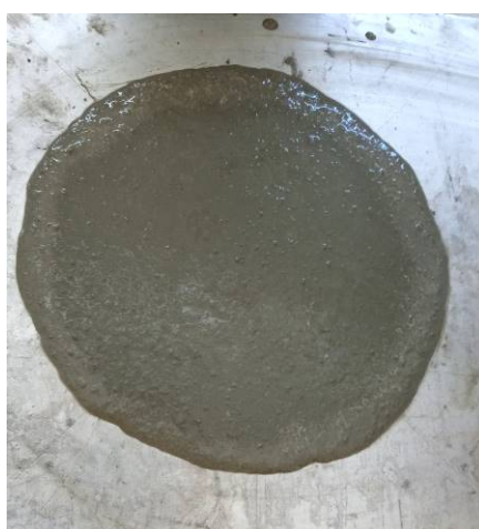
Εικόνα 5.1: Εξάπλωση μίγματος σύνθεσης MP20
