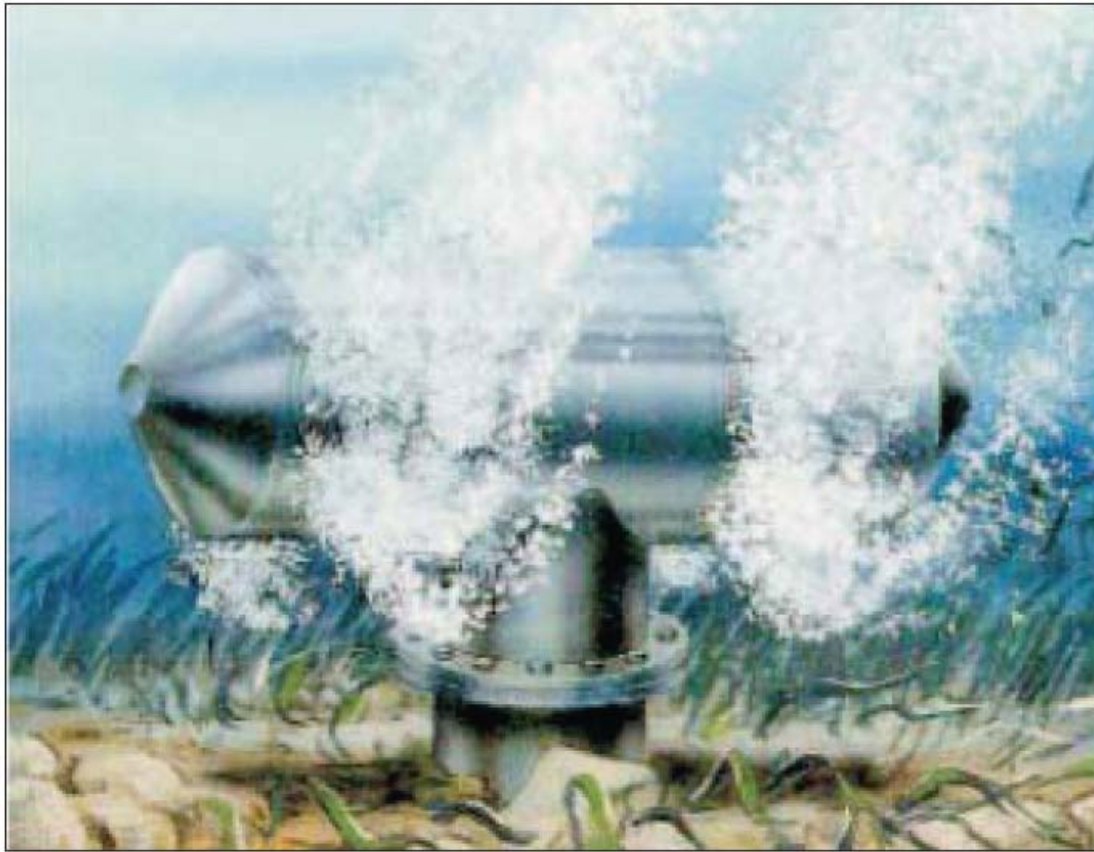
Σχήμα 2.6: Παθητική σχάρα που καθαρίζεται με ριπές αέρα ( πηγή: Johnson Screens and Tom Pankratz, τροποποιήθηκε από Missimer το 2009 /1/).
