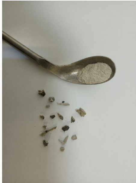
Σχήμα 5.3 Καθαρή κοσκινισμένη ουσία προερχόμενη από σκωρία που παράχθηκε στο If.
