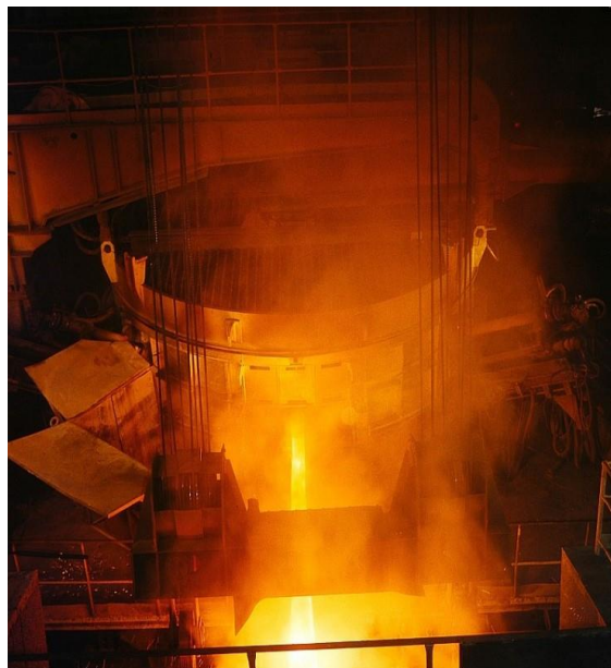
Σχήμα 3.9: Η φάση της ανατροπής του μετάλλου από τον κλίβανο στον κάδο.
