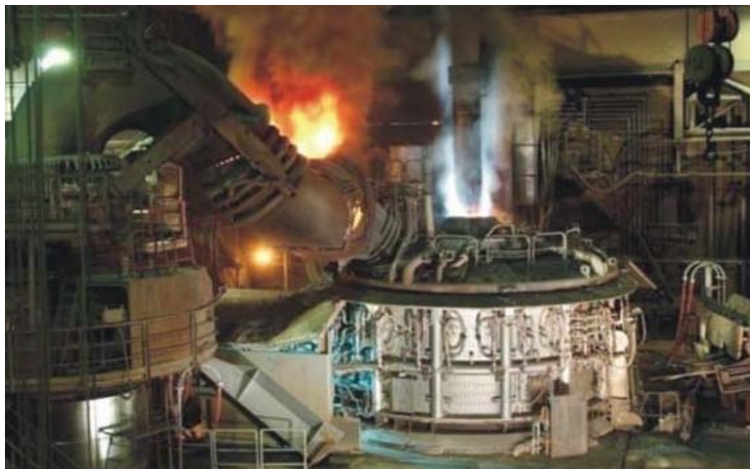
Σχήμα 3.4 EAF κατά τη διάρκεια τήξης του scrap.
