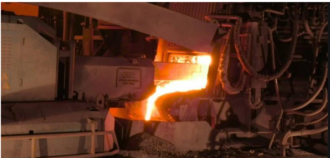
Σχήμα 3.5: Ο κλίβανος έχει πάρει ελαφριά κλίση, η θύρα αποσκωρίωσης έχει ανοίξει και με τη βοήθεια του μηχανήματος απομακρύνονται τμήματα της «κρούστας» στερεοποιημένου μετάλλου που εμποδίζουν τη ροή της σκουριάς προς τα έξω.
