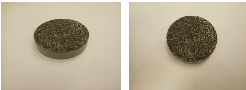
Σχήμα 5.2: Δείγμα που παράχθηκε από τα παραπάνω κομμάτια σκωρίας του eaf (με κονιοποίηση και πρέσσα)
