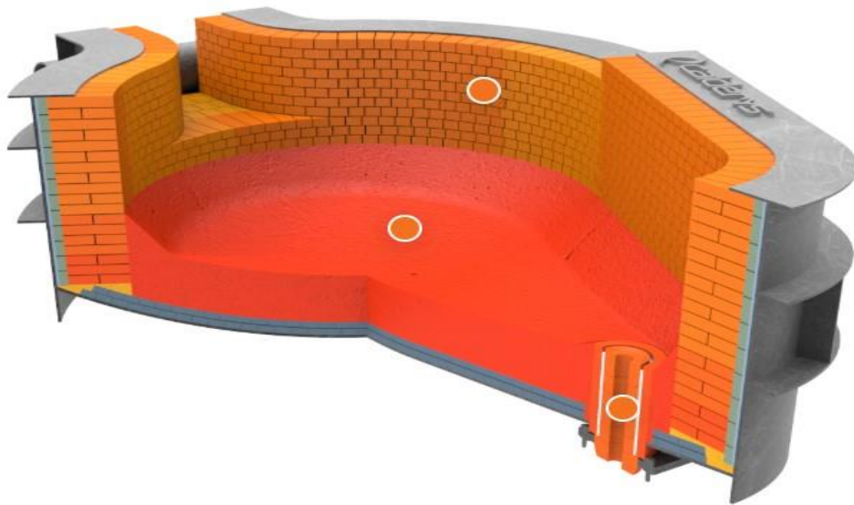
Σχήμα 3.3: eaf: eccentric bottom tapping, ebt.
