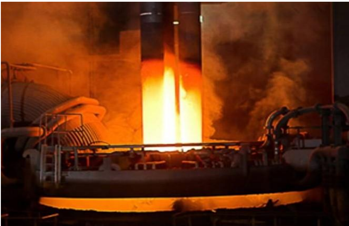
Σχήμα 3.2: Τα ηλεκτρόδια και η ανοιγόμενη οροφή του eaf .
