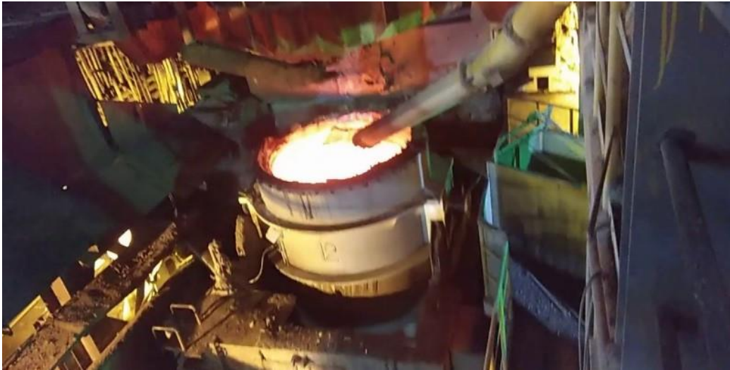
Σχήμα 3.8: Προσθήκη συλλιπασμάτων κατά τη φάση ανατροπής του μετάλλου από τον κλίβανο στον κάδο.
