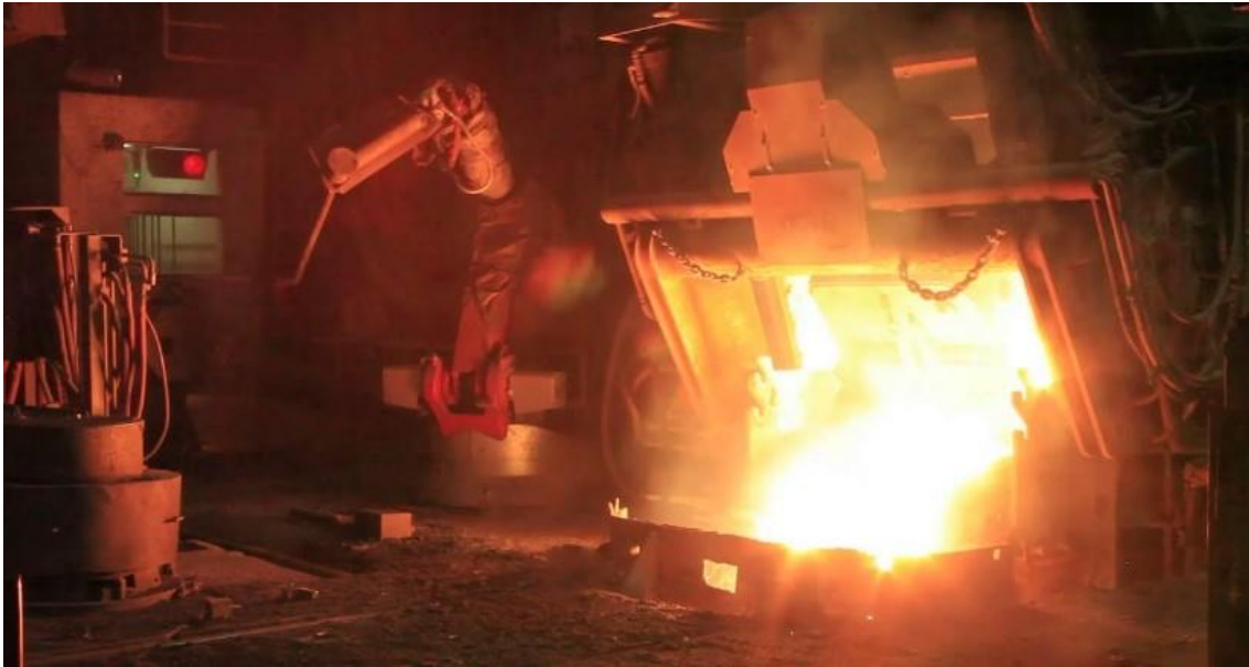
Σχήμα 3.6: Η σκουριά ρέει από τη θύρα αποσκωρίωσης του κλιβάνου.
