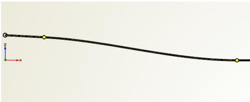
Σχήμα 10: Καμπύλη τροπίδας με το σημείο της αρχής της ( x=0 ), το πρώτο ενδιάμεσο σημείο της (αριστερό κίτρινο σημείο) και το δεύτερο ενδιάμεσο σημείο της (δεξιό κίτρινο σημείο)
