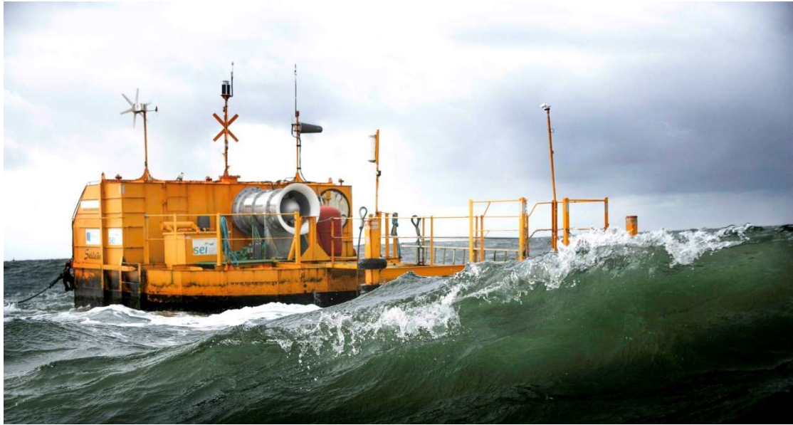
Εικόνα 2.23 Μοντέλο σε κλίμακα 1:4 πλωτής συσκευής ταλαντευόμενης υδάτινης στήλης Ocean Energy Buoy [61]
