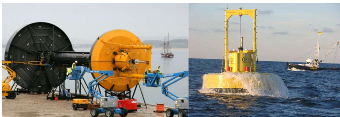
Εικόνα 2.10: Διάταξη σημειακού κυματικού απορροφητήρα δύο κινούμενων σωμάτων της Ocean Power Technologies [48], [39]
