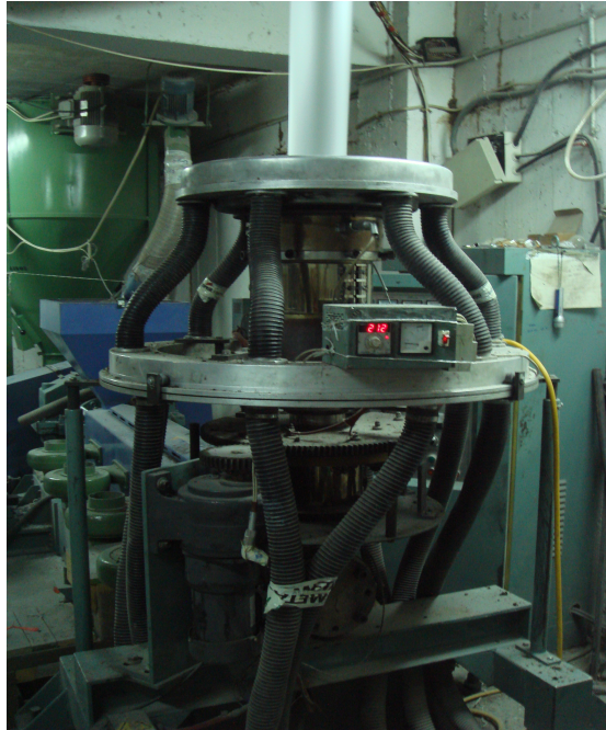
Εικόνα 9.2.β Δακτυλίδια αέρος μήτρας εκβολής με εμφύσηση
