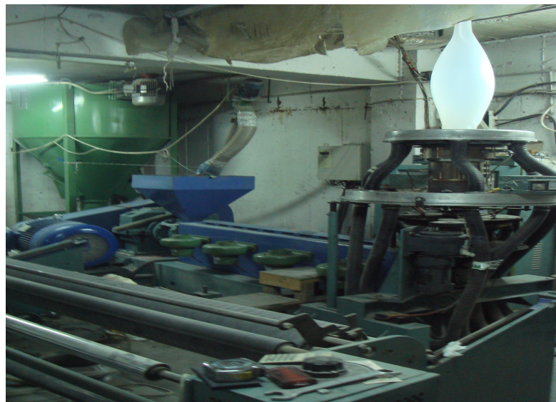
Εικόνα 9.2.α Ολοκληρωμένη διάταξη εκβολέα παραγωγής
