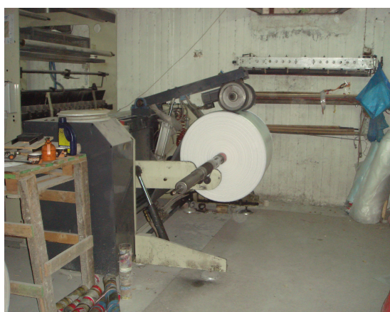
Εικόνα 9.4.γ Ρολό προϊόντος παραγωγής έτοιμο για κοπή
