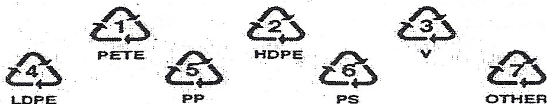
Σχήμα 7.3.2.α Σήμανση πλαστικών με χρήση κωδίκων.
