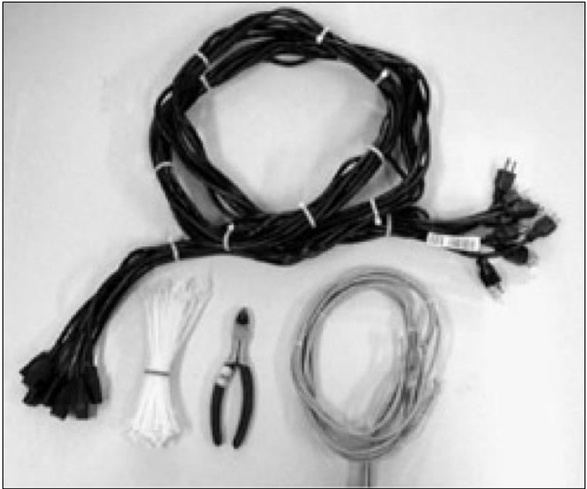
Εικόνα 63. Cable Bundles: Tires καλωδίων σχηματίζουν μία καλά διαχειρίσιμη ομάδα 8 καλωδίων.
