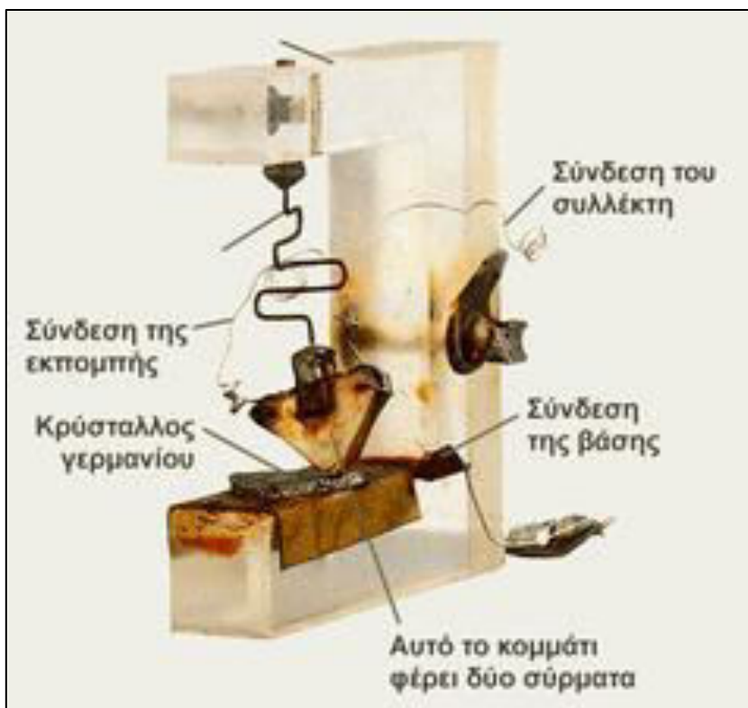
Εικόνα 14. Η συνδεσμολογία του πρώτου τρανζίστορ (1947) 17 .
