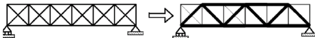
Σχ.1 Βελτιστοποίηση μεγέθους (sizing) (Πηγή: https://www.researchgate.net )
