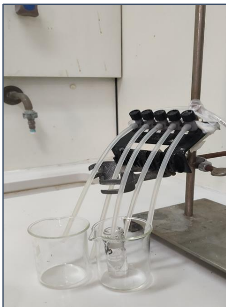
Εικόνα 12.2: Εξάτμιση με τη χρήση αέριου αζώτου του 1 mL του οξικού αιθυλεστέρα στο φιαλίδιο κωνικού πάτου.
