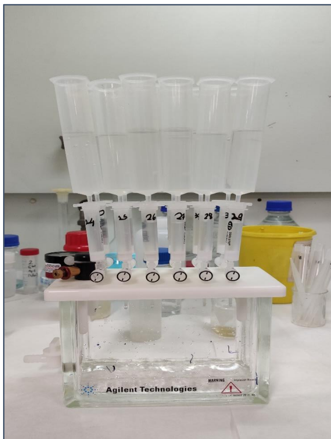
Εικόνα 12.1: Φωτογραφική απεικόνιση της συσκευής κενού (Agilent Technologies), των πλαστικών συριγγών και των φυσιγγών C18 που χρησιμοποιούνται κατά την εκχύλιση στερεής φάσης.
