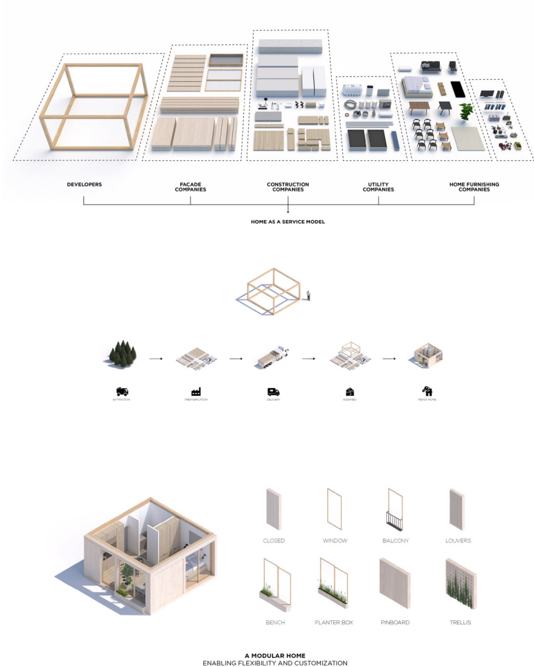
Εικ 6.7.2: Λεπτομέρειες στοιχείων που απαρτίζουν την κατασκευή
