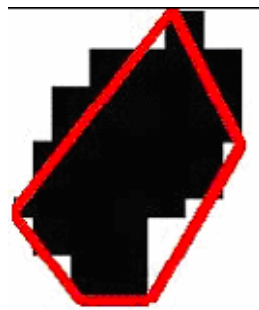
Εικόνα 2-15: Αντικείμενο εικόνας σε raster Μορφή και το περίγραμμά του μετά τη διανυσματοποίηση
