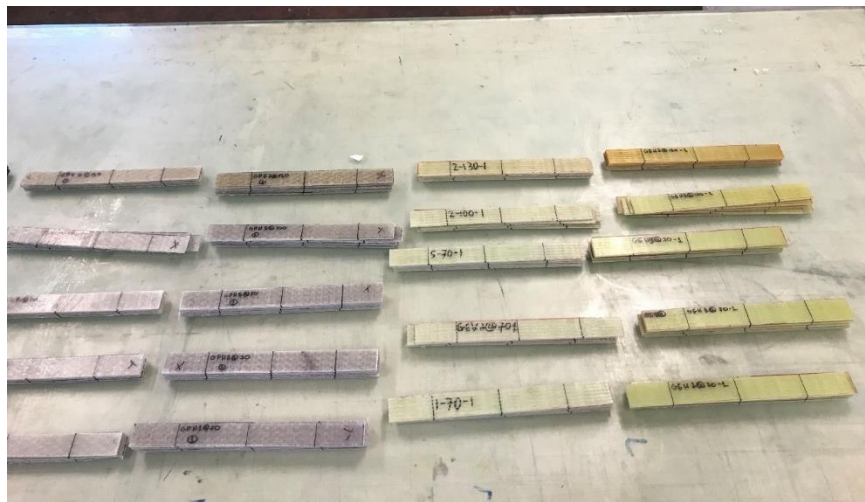
Σχήμα 2.5: Δοκίμια από γυαλί συνδυασμένο CSM / WR και UD.
