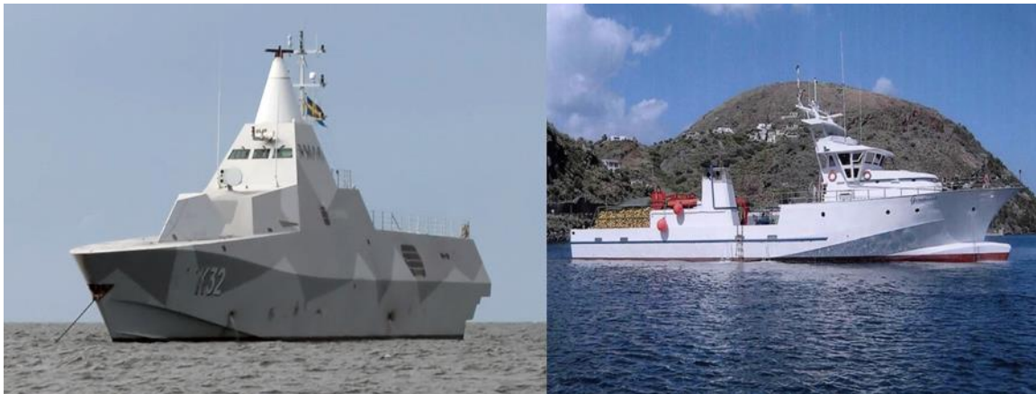
Σχήμα 1.1: Αριστερά: Σουηδικό ναρκαλιευτικό κατασκευασμένο από CFRP. (L=72.7m), τιμή $184 εκατομμύρια. Δεξιά: Αλιευτικό σκάφος κατασκευασμένο από GRP. (L=42m).
