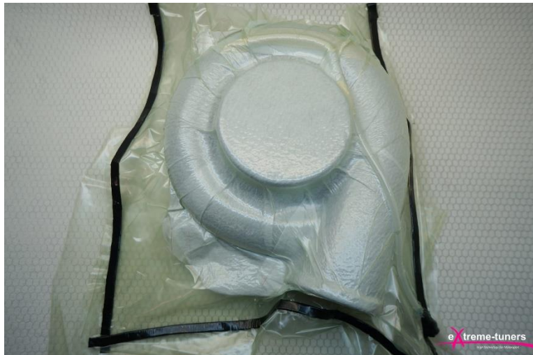
Σχήμα 1.2: Κάλυμμα υπερπληρωτή Μ.Ε.Κ κατασκευασμένο εν κενό.
