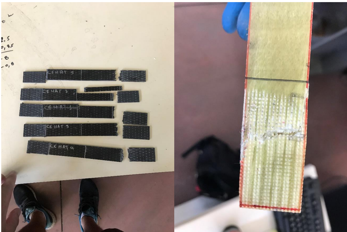
Σχήμα 3.51: Δοκίμια που έσπασαν στις αρτάγες. Αυτό το είδος θραύσης δεν είναι επιθυμητό καθώς θα έπρεπε να σπάσει στη μέση ούτως ώστε να καταφέρει να παραλάβει το μέγιστο φορτίο.
