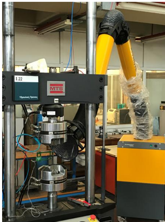
Σχήμα 3.1: Δοκίμιο UD άνθρακα έτοιμο για το πείραμα εφελκυσμού.
