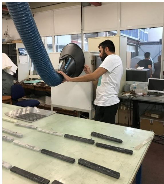
Σχήμα 2.7: Προσαρμογή απορροφητήρα στο στόμιο του φούρνου.
