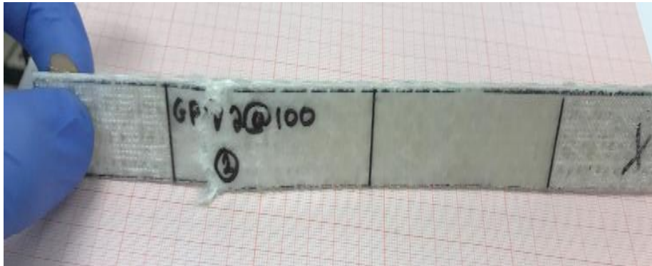
Σχήμα 3.48: Δοκίμιο GPV_2@100_1 μετά τη θραύση.
