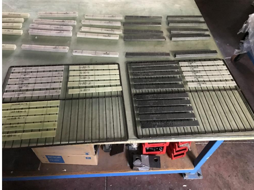
Σχήμα 2.6: Δοκίμια από όλους τους συνδυασμούς παραμέτρων στο σενάριο θέρμανσης 5 ώρες στους 70 °C.
