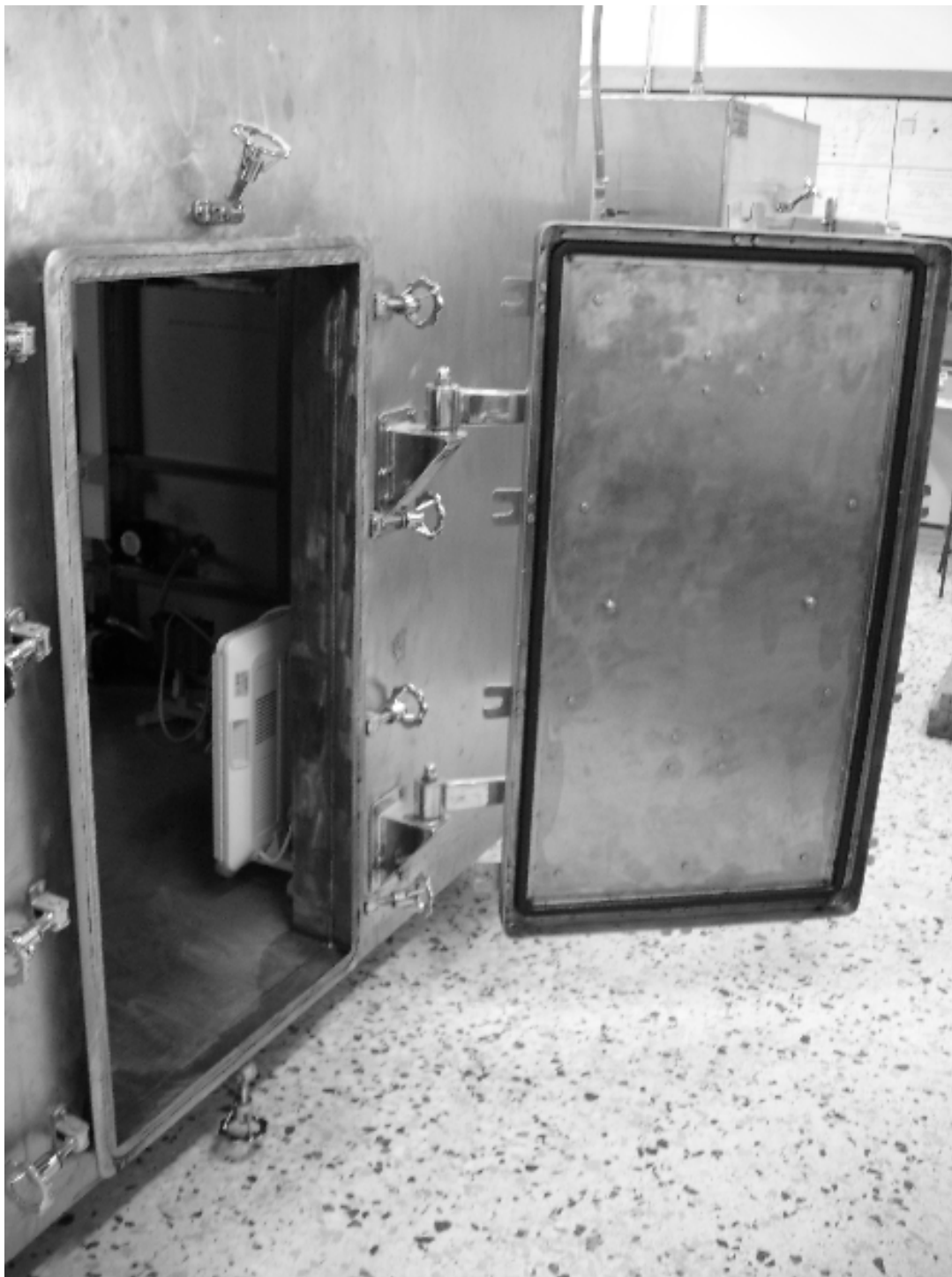
Διάγραμμα 5.2 Ελαστικό παρέμβυσμα στεγάνωσης θύρας θαλάμου "B"
