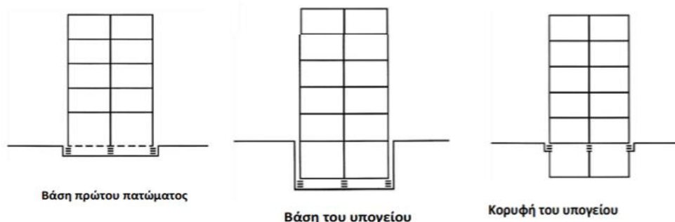
Εικόνα 2.4 Πιθανές θέσεις τοποθέτησης της σεισμική μόνωσης.
