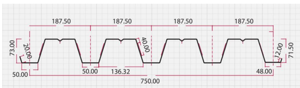
Εικόνα 7.1. Τεχνικό διάγραμμα του χαλυβδόφυλλου SymDeck73.
