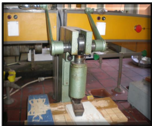
Εικόνα 5: Αριστερά το μηχάνημα κοπής δοκιμίων dogbone, δεξιά η διάταξη δοκιμής σε εφελκυσμό
