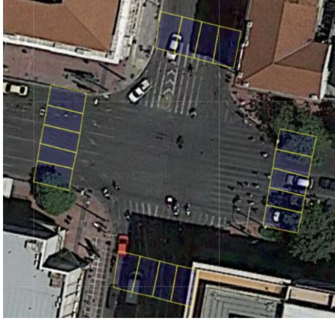
Εικόνα 4.2-13 Επιφάνειες ανίχνευσης σε υπόβαθρο χάρτη
