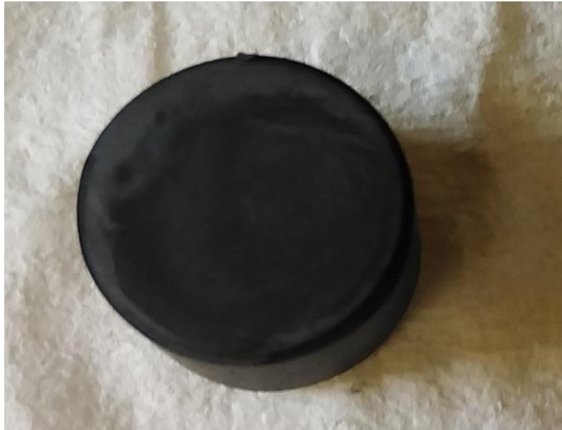
Εικόνα 6.44: Η επιφάνεια των δοκιμίων ύστερα από την ηλεκτροχημική απόθεση του ανόργανου ημιαγωγού CdSe παρουσία φερροκενίου (Fc).
