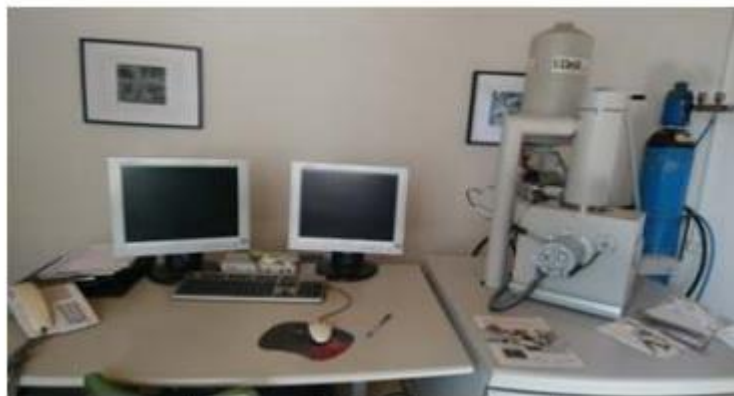
Εικόνα 5.3: Η διάταξη που χρησιμοποιήθηκε κατά την πειραματική διαδικασία (εταιρεία FEI μοντέλο Quanta 200)
