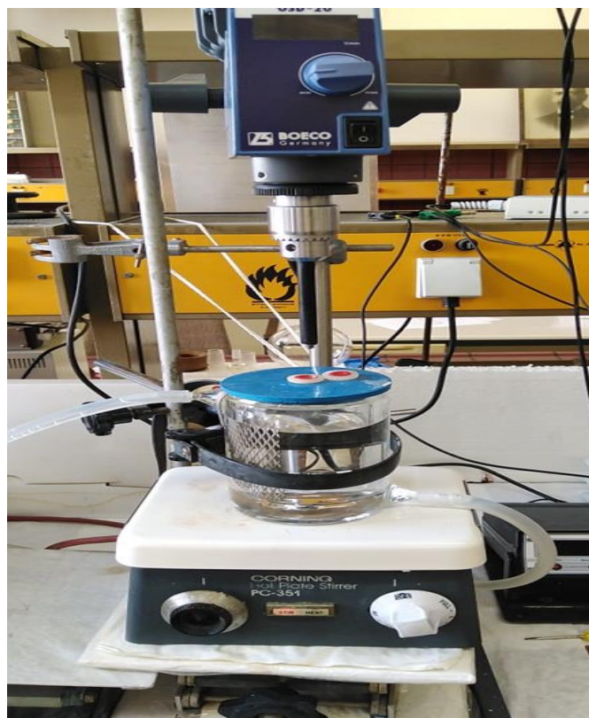
Εικόνα 4.5: Ηλεκτρολυτικό λουτρό ανόργανου ημιαγωγού CdSe
