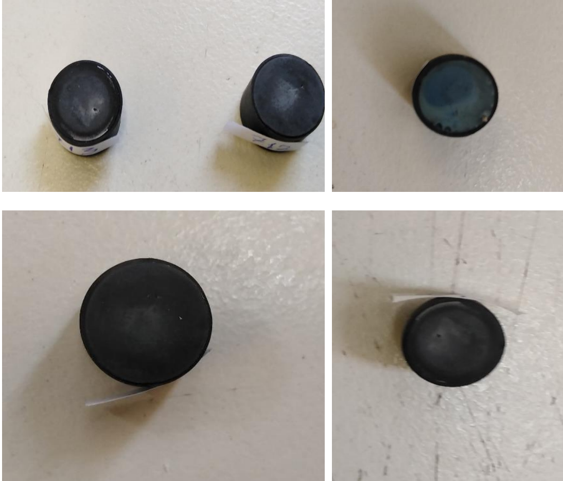
Εικόνα 6.15: Η επιφάνεια των δοκιμίων ύστερα από την απόθεση του ανόργανου ημιαγωγού CdSe
