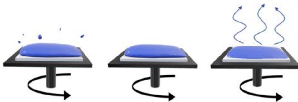
Εικόνα 1.2: Η μέθοδος της εναπόθεσης πολλαπλών στρωμάτων (spin coating) [29]
