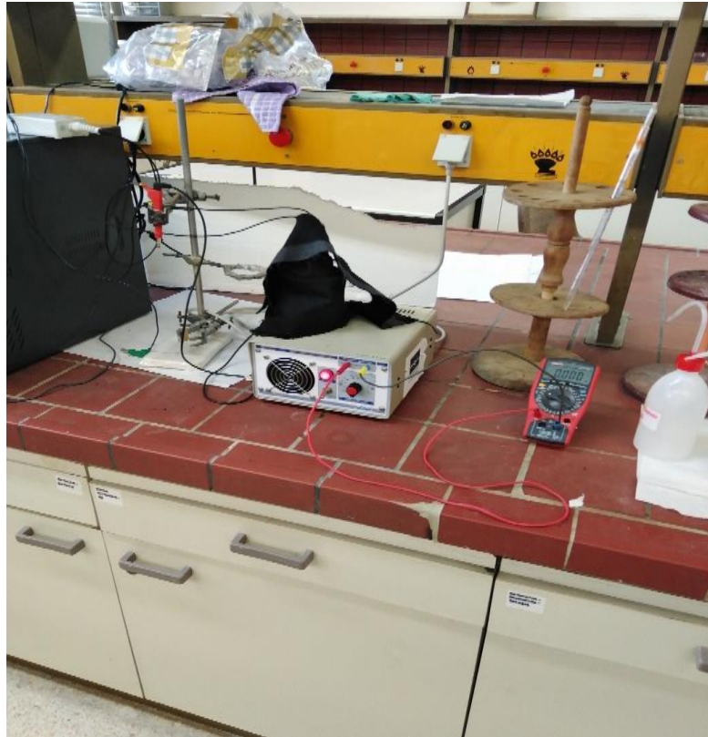
Εικόνα 5.8: Οργανολογία της φωτοηλεκτροχημικής κυψελίδας σε συνθήκες σκότους.
