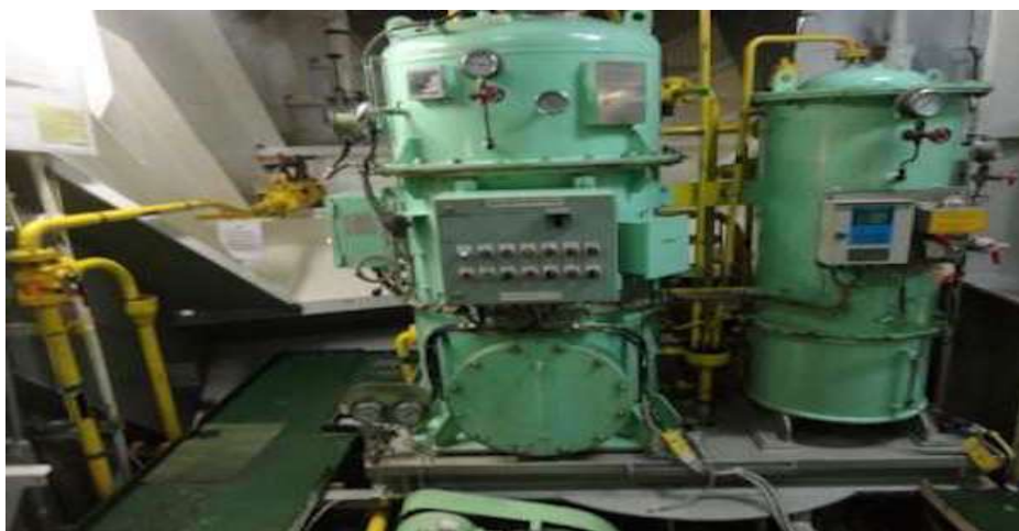
Σχήμα 6.64 Διαχωριστής νερού-ελαίων εντός πλοίου.
