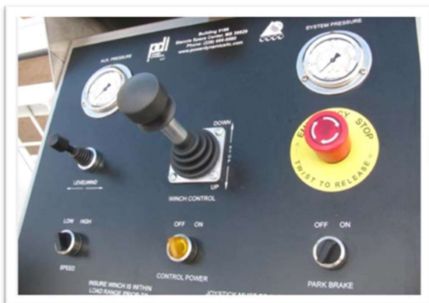
Σχήμα 4.41 HMI παλαιού τύπου. Προσφέρονται επιλογές εποπτείας και ελέγχου αλλά περιορίζονται στα βασικά και απολύτως αναγκαία δεδομένα και λειτουργίες.
