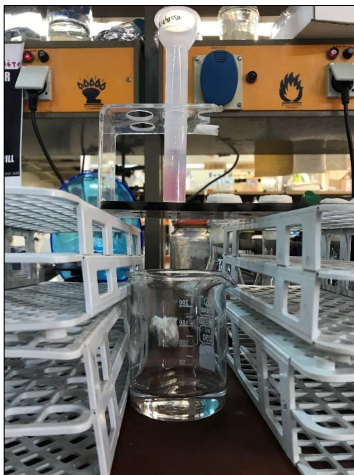
Εικόνα 3.10 Στήλη βαρύτητας (Biorad, Η.Π.Α.) πληρωμένη με ρητίνη Talon® ακίνητοποιημένων ιόντων κοβαλτίου (Clontech, Η.Π.Α) κατά τη διάρκεια καθαρισμού της ανασυνδυασμένης πρωτεΐνης με Χρωματογραφία Συγγένειας Ακίνητοποιημένου Μετάλλου (IMAC). Η ρητίνη διακρίνεται με ρόζ χρώμα στο κάτω μέρος της στήλης.
