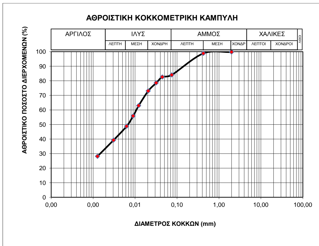
Σχήμα 6.2: Αθροιστική κοκκομετρική καμπύλη λεπτόκοκκου εδάφους
