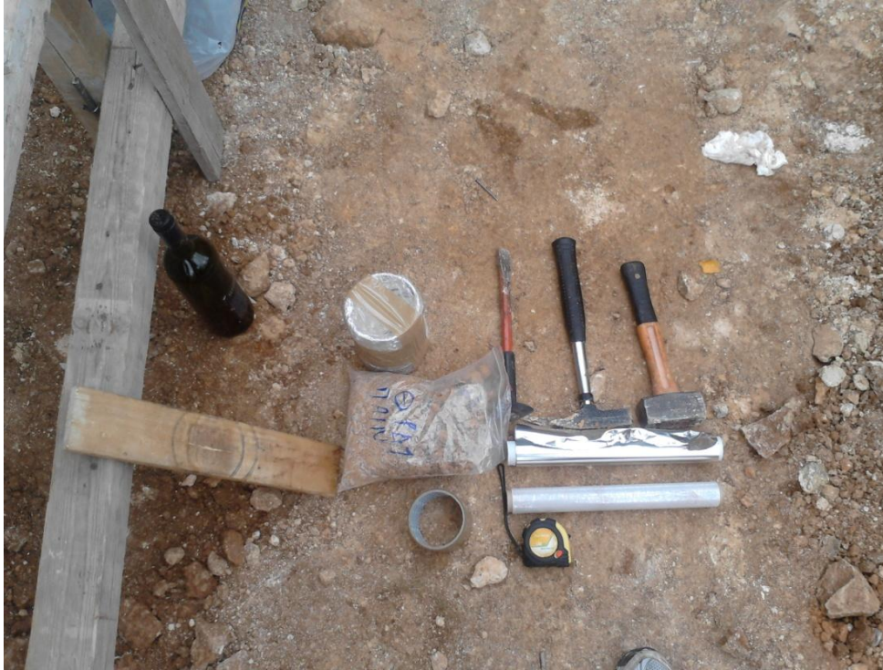
Φωτογραφία 6.2: Δείγματα και όργανα δειγματοληψίας
