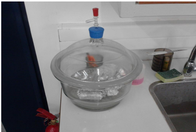
Φωτογραφία 13 Υγραντήρας για τη διατήρηση της υγρασίας των δοκιμίων
