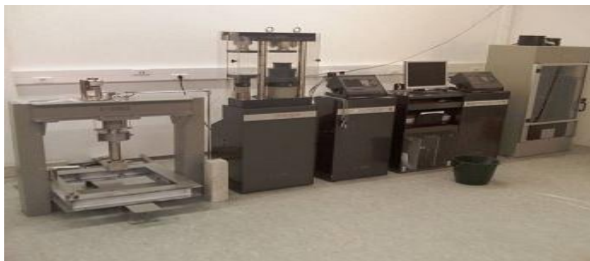
Φωτογραφία 6.16 (Από δεξιά προς τα αριστερά) Αυτόματη πρέσα θραύσης, ικανότητας 5000 kN, με 4 διαφορετικές ειδικές διατάξεις για την εκτέλεση δοκιμών θλίψης, κάμψη και τριαξονικής φόρτισης σε βραχώδους σχηματισμούς.
