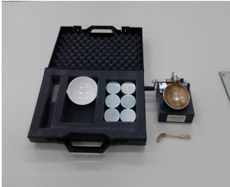
Φωτογραφία 3 Συσκευή Cassagrande, όργανο χάραξης, κάψες και δοχείο ανάμιξης του δείγματος με νερό
