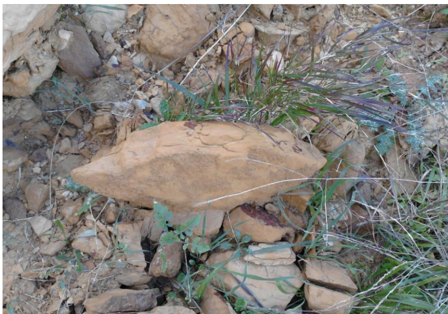
Φωτογραφία 6.3: Μαργαϊκός σχηματισμός που λήφθηκε για εργαστηριακές δοκιμές
