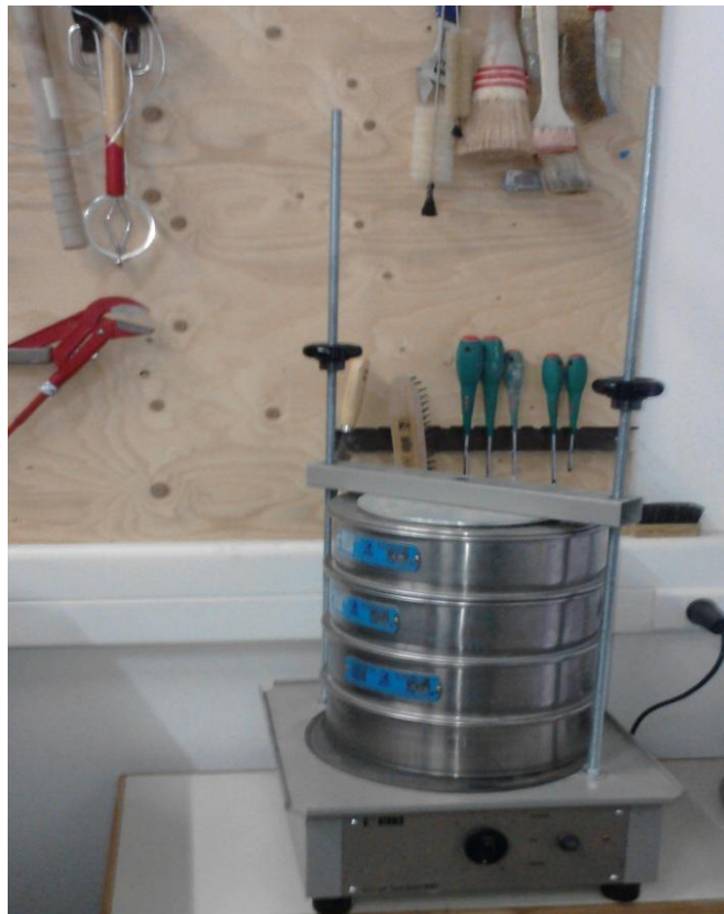
Φωτογραφία 1 Χρησιμοποιούμενη σειρά κοσκίνων πάνω στον ηλεκτρομαγνητικό δονητή
