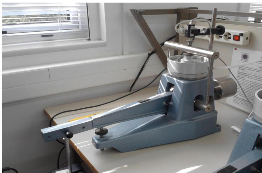
Φωτογραφία 10 Συσκευή φόρτισης εργαστηρίου Τεχνικής Γεωλογίας και Υδρογεωλογίας
