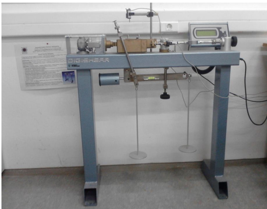
Φωτογραφία 6.15: Συσκευή άμεσης διάτμησης του εργαστηρίου Τεχνικής Γεωλογίας και Υδρογεωλογίας
