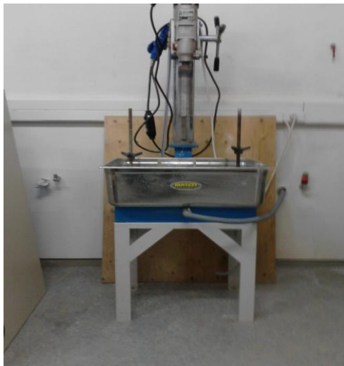
Φωτογραφία 6.5: Συσκευής προετοιμασίας κυλινδρικών δειγμάτων εργαστηρίου Τεχνικής Γεωλογίας και Υδρογεωλογίας
