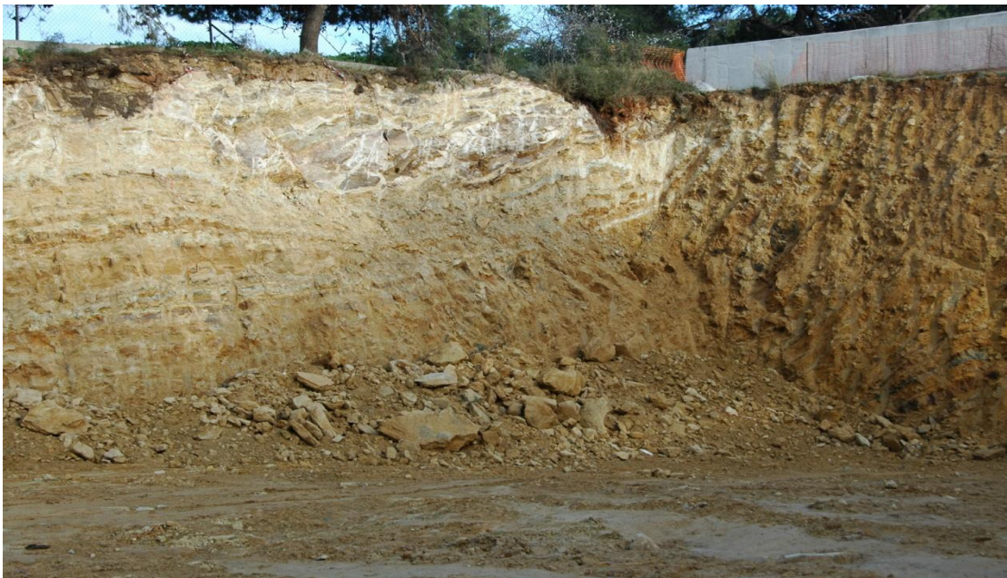
Φωτογραφία 7.4: Χαρακτηριστική τομή μαργαϊκών ασβεστόλιθων στα ανώτερα μέλη σχηματισμών στη θέση όπου προοριζόταν η ανέγερση του Ιατρικού Πάρκου Αθηνών
