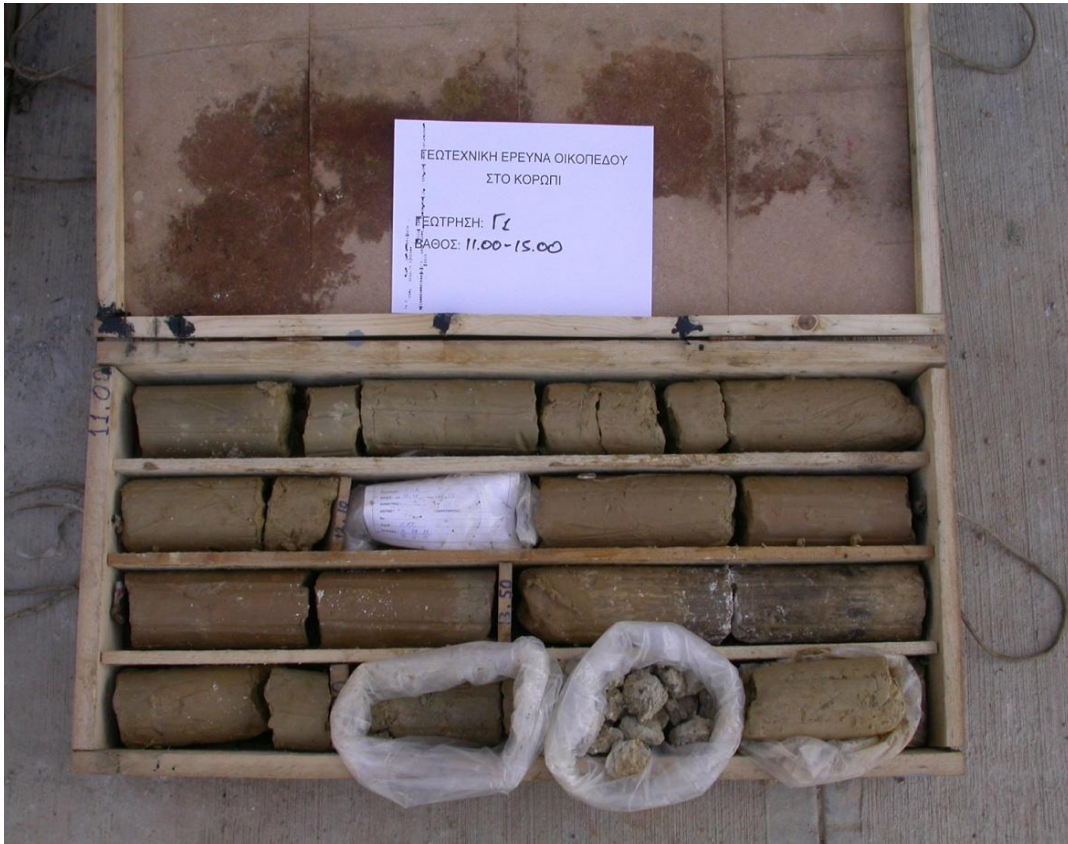
Φωτογραφία 7:5 Αντιπροσωπευτικά δείγματα από γεώτρηση στην περιοχή του Κορωπίου(ΕΛΑΦΟΜΗΧΑΝΙΚΗ Α.Τ.Ε) που έχει διατρήσει την ομάδα των νεογενών σχηματισμών μεικτών φάσεων. (Βάθος 11-15m)
