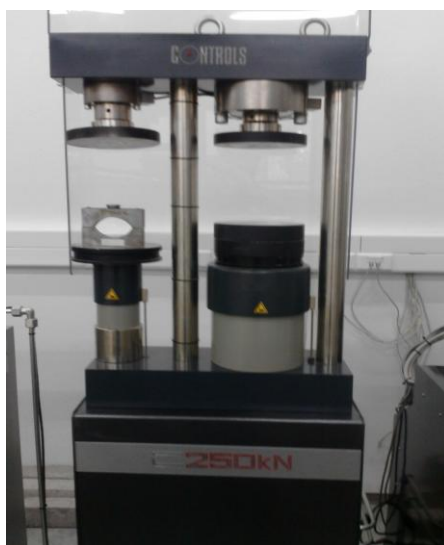
Φωτογραφία 6.19 Κελί υποδοχή δοκιμίου και συσκευή φόρτισης
