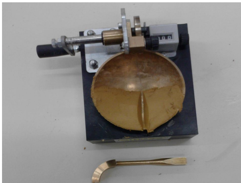
Φωτογραφία 6 Ανοιχτή χαραγή του δείγματος
