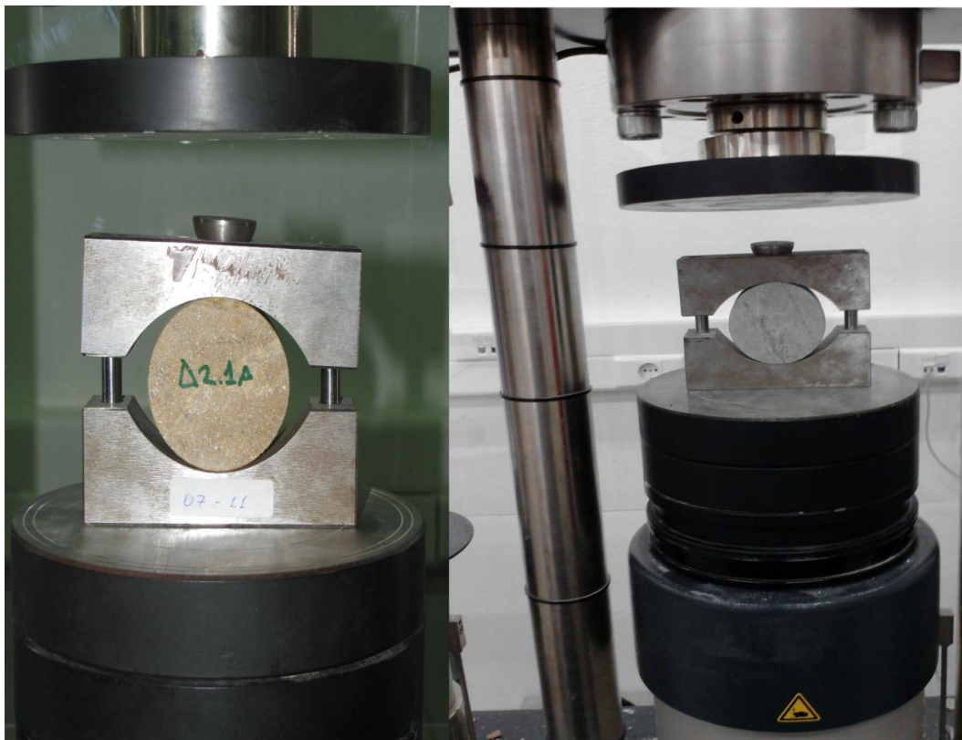
Φωτογραφία 19 Εφαρμογή της δοκιμής Brazilian σε δοκίμια ψαμμίτη και ασβεστόλιθου
