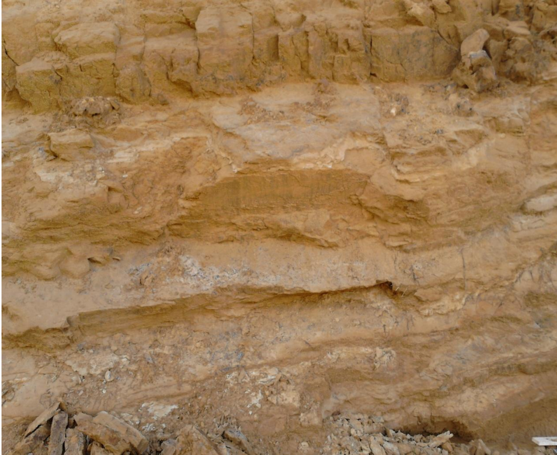
Φωτογραφία 7.3 Τομή μαργαϊκών σχηματισμών στη θέση όπου προοριζόταν η ανέγερση του Ιατρικού Πάρκου Αθηνών.
