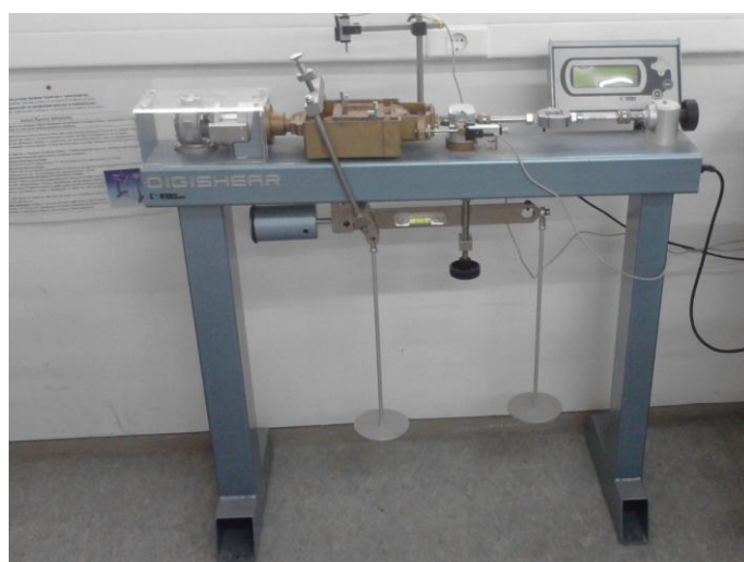
Φωτογραφία 16 Συσκευή άμεσης διάτμησης εργαστηρίου Τεχνικής Γεωλογίας και Υδρογεωλογίας
