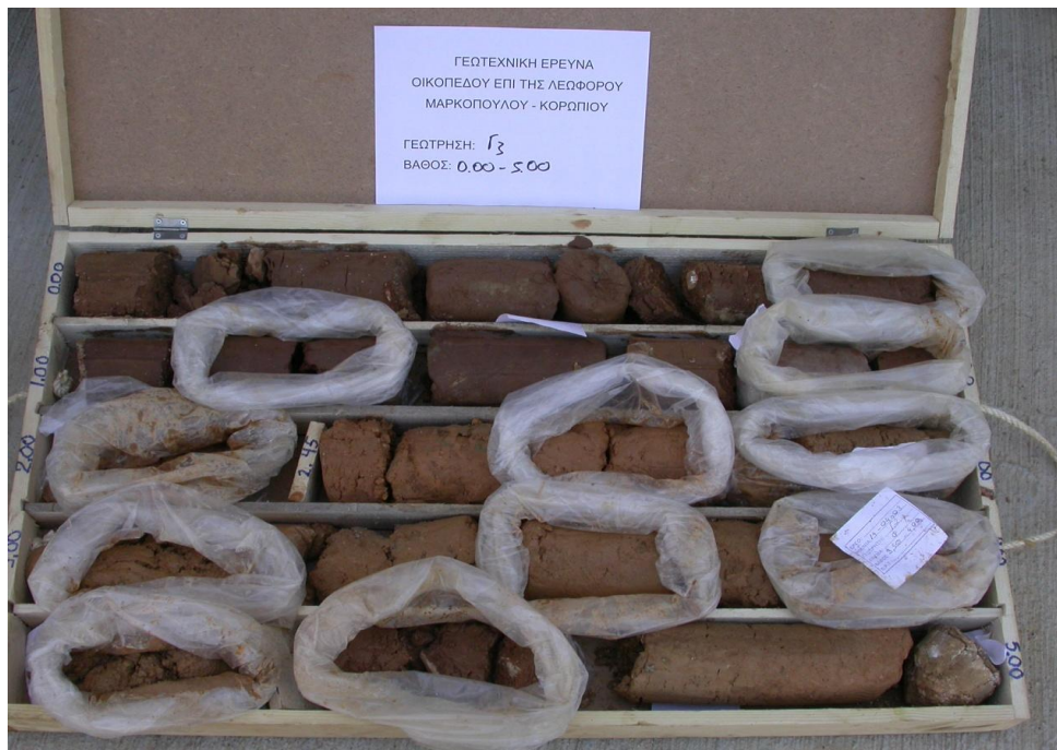
Φωτογραφία 7.2: Πυρήνες γεώτρησης από την περιοχή του Κορωπίου (Εδαφομηχανική Α.Τ.Ε) που έχει διατρήσει την ομάδα των τεταρτογενών σχηματισμών.(Βάθος 0-5m)
