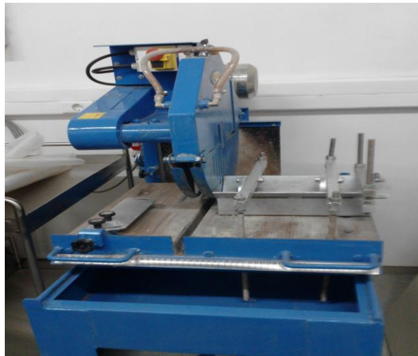
Φωτογραφία 6.6: Αδαμαντοτροχός εργαστηρίου Τεχνικής Γεωλογίας και Υδρογεωλογίας
