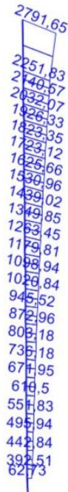
Σχήμα 3.35: Απεικόνιση διαγράμματος αξονικών δυνάμεων κατακόρυφου μέλους συνδυασμού φόρτισης COMB4. Οι τιμές των δυνάμεων απεικονίζονται σε kN.
