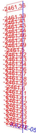
Σχήμα 3.159: Απεικόνιση διαγράμματος τεμνουσών δυνάμεων V3-3 κατακόρυφου μέλους συνδυασμού φόρτισης COMB6. Οι τιμές των δυνάμεων απεικονίζονται σε kN.
