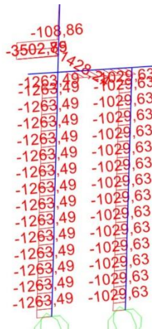
Σχήμα 3.160: Απεικόνιση διαγράμματος αξονικών δυνάμεων 1 ου ζεύγους πασσάλων συνδυασμού φόρτισης COMB6. Οι τιμές των δυνάμεων απεικονίζονται σε kN.
