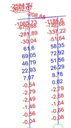
Σχήμα 3.163: Απεικόνιση διαγράμματος τεμνουσών δυνάμεων V2-2 1 ου ζεύγους πασσάλων συνδυασμού φόρτισης COMB6. Οι τιμές των δυνάμεων απεικονίζονται σε kN.
