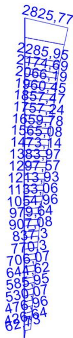
Σχήμα 3.155: Απεικόνιση διαγράμματος αξονικών δυνάμεων κατακόρυφου μέλους συνδυασμού φόρτισης COMB6. Οι τιμές των δυνάμεων απεικονίζονται σε kN.
