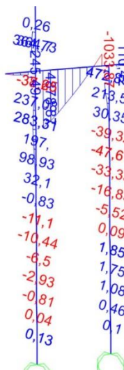
Σχήμα 3.161: Απεικόνιση διαγράμματος καμπτικών ροπών M2-2 1 ου ζεύγους πασσάλων συνδυασμού φόρτισης COMB6. Οι τιμές των ροπών απεικονίζονται σε kNm.
