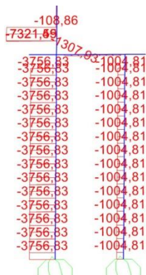
Σχήμα 3.100: Απεικόνιση διαγράμματος αξονικών δυνάμεων 1 ου ζεύγους πασσάλων συνδυασμού φόρτισης COMB5. Οι τιμές των δυνάμεων απεικονίζονται σε kN.
