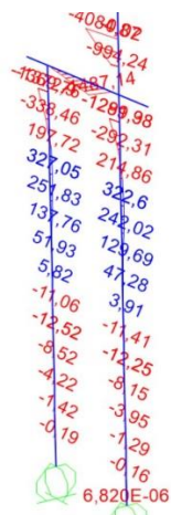
Σχήμα 3.52: Απεικόνιση διαγράμματος καμπτικών ροπών M3-3 3 ου ζεύγους πασσάλων συνδυασμού φόρτισης COMB4. Οι τιμές των ροπών απεικονίζονται σε kNm.
