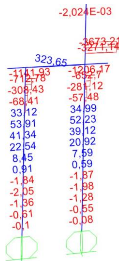
Σχήμα 3.103: Απεικόνιση διαγράμματος τεμνουσών δυνάμεων V2-2 1 ου ζεύγους πασσάλων συνδυασμού φόρτισης COMB5. Οι τιμές των δυνάμεων απεικονίζονται σε kN.
