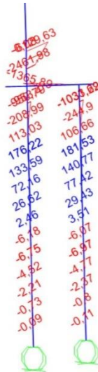
Σχήμα 3.107: Απεικόνιση διαγράμματος καμπτικών ροπών M3-3 2 ου ζεύγους πασσάλων συνδυασμού φόρτισης COMB5. Οι τιμές των ροπών απεικονίζονται σε kNm.
