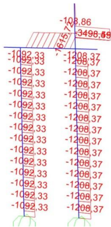
Σχήμα 3.165: Απεικόνιση διαγράμματος αξονικών δυνάμεων 2 ου ζεύγους πασσάλων συνδυασμού φόρτισης COMB6. Οι τιμές των δυνάμεων απεικονίζονται σε kN.
