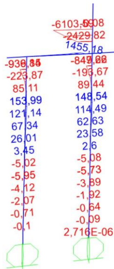
Σχήμα 3.102: Απεικόνιση διαγράμματος καμπτικών ροπών M3-3 1 ου ζεύγους πασσάλων συνδυασμού φόρτισης COMB5. Οι τιμές των ροπών απεικονίζονται σε kNm.
