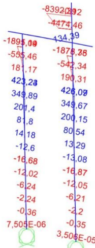
Σχήμα 3.172: Απεικόνιση διαγράμματος καμπτικών ροπών M3-3 3 ου ζεύγους πασσάλων συνδυασμού φόρτισης COMB6. Οι τιμές των ροπών απεικονίζονται σε kNm.
