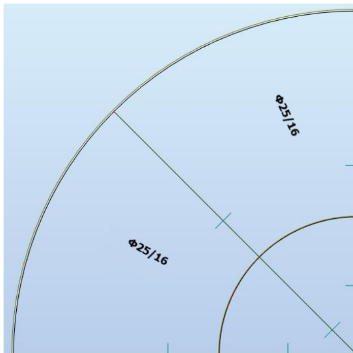
Σχήμα 6-11: Διάταξη ακτινικού οπλισμού κάμψης άνω πέλματος
