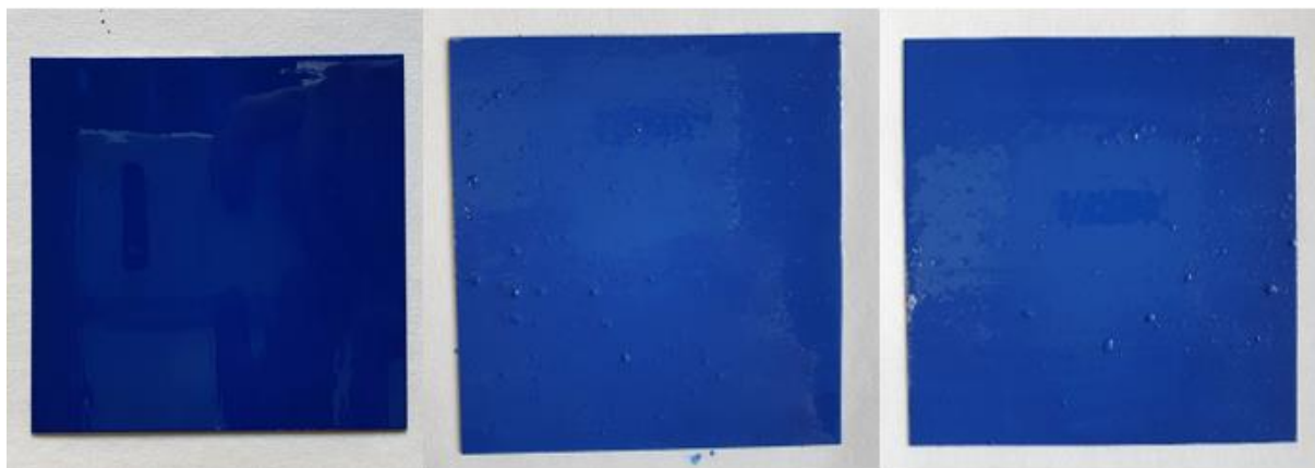
Εικόνα 3.8 Ξεκινώντας από αριστερά: Δοκίμιο 1 (αναφοράς), Δοκίμιο 2 (με Aluminium (III) Triflate), Δοκίμιο 3 (με αιθυλενοδιαμίνη).
