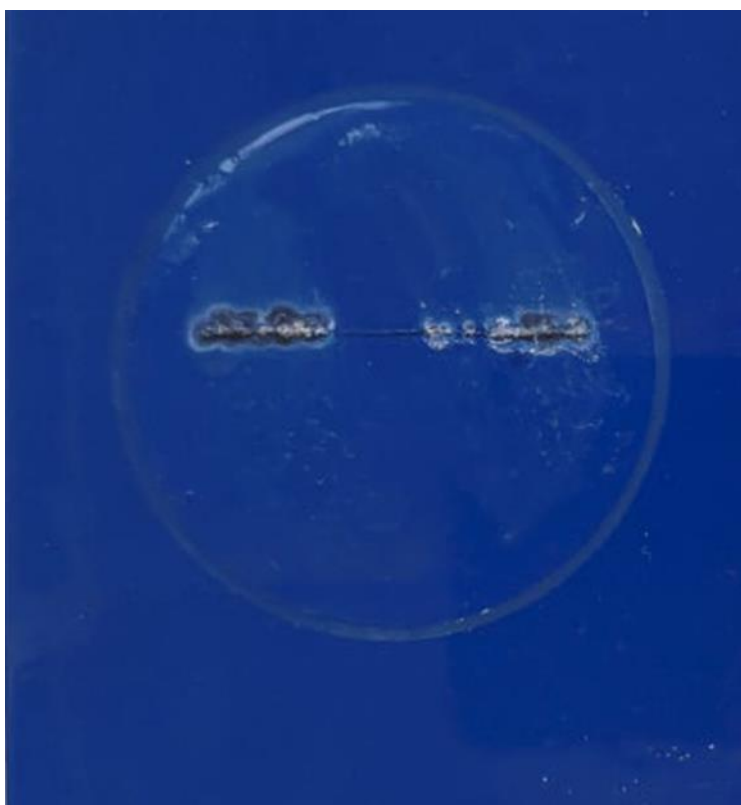
Εικόνα 5.2 Δοκίμιο αναφοράς μετά από 9 ημέρες μετρήσεων, ρωγμή με κοπίδι σε μορφή ευθείας γραμμής.
