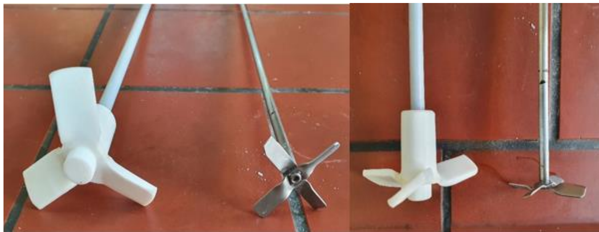
Εικόνα 3.2 Προπέλες που χρησιμοποιήθηκαν στα πειράματα.
