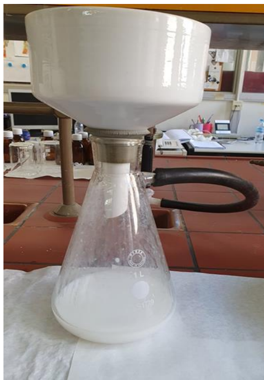
Εικόνα 3.4 Απεικόνιση διάταξης διήθησης υπό κενό.
