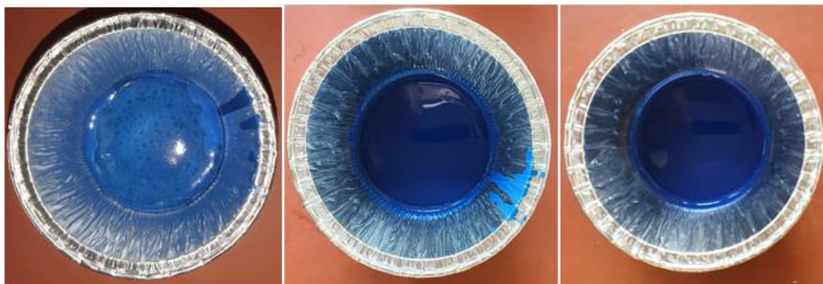
Εικόνα 3.6 Ξεκινώντας από τα αριστερά: δοκιμή 1 (βαφή και αιθυλενοδιαμίνη), δοκιμή 2 (βαφή και Aluminium (III) Triflate), δοκιμή 3 (μόνο βαφή).
