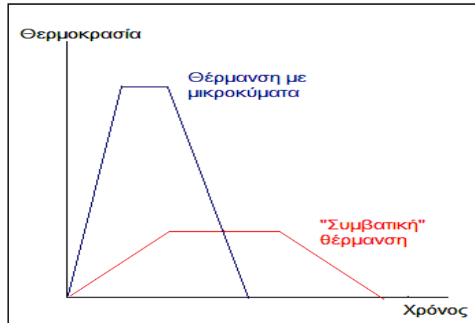
Εικόνα 1.12. Διαφορές στο προφίλ θερμοκρασίας-χρόνου για μια αντίδραση όπου γίνεται θέρμανση συμβατικά και με μικροκύματα. Ιδιαίτερα αξιοσημείωτο είναι πως με τη μέθοδο με τα μικροκύματα, επιτυγχάνονται πολύ υψηλότεροι ρυθμοί θέρμανσης και ψύξης και η θέρμανση επιτυγχάνεται σε πολύ μικρότερο χρόνο. 6
