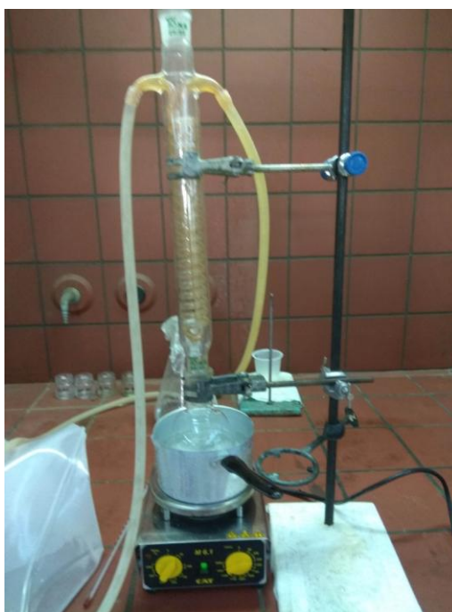
Εικόνα 23. Πειραματική διάταξη για την παρασκευή του γαλακτώματος
