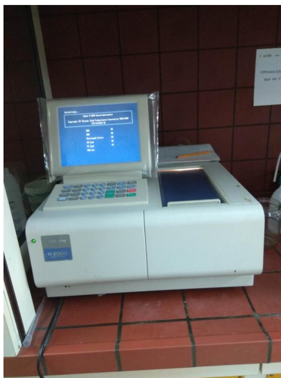
Εικόνα 21. Φωτόμετρο μονής δέσμης Hitachi U-2900
