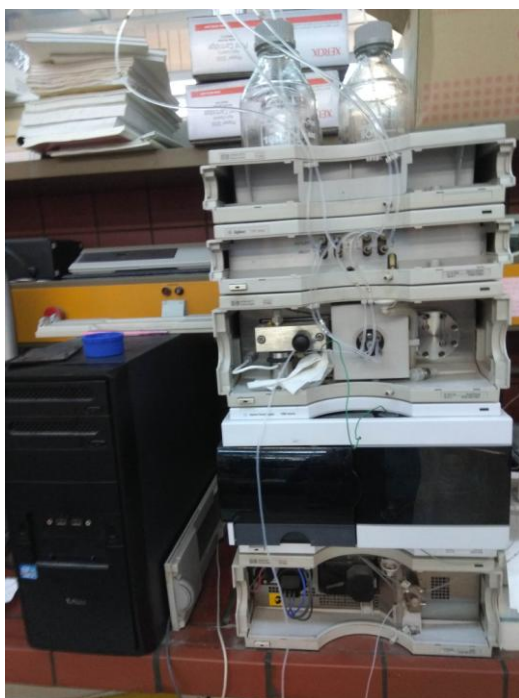
Εικόνα 20. Σύστημα υγρής χρωματογραφίας υψηλής απόδοσης
