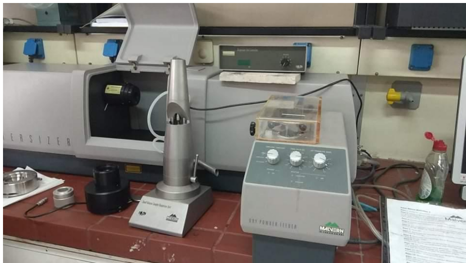
Εικόνα 25. Συσσκευή Malvern Mastersizer για τον προσδιορισμό του μεγέθους των σωματιδίων του γαλακτώματος
