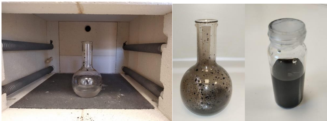
Εικόνα 52: Η σφαιρική φιάλη τοποθετείται στο πυραντήριο (αριστερά). Κατά τη θέρμανση αρχίζει να σχηματίζεται ένα σκούρο καφέ στερεό (κέντρο). Οι τελείες άνθρακα έπειτα από διήθηση (δεξιά).
