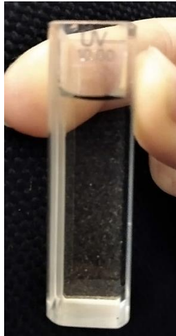
Εικόνα 60: Δείγμα 120min κατά τη δοκιμασία αποχρωματισμού του δείγματος TiO 2 -Cdots_B25.
