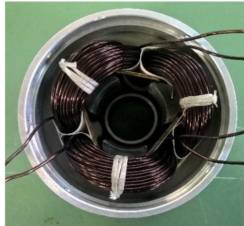
Σχήμα 6.2: Εσωτερικό Ηλεκτρικής Μηχανής (Στάτης)
