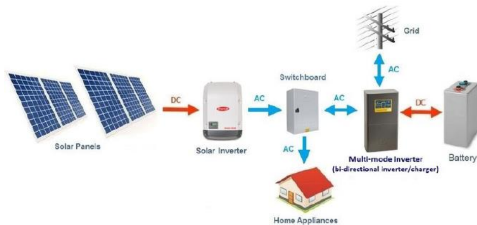
Εικόνα 24: Υβριδικό Σύστημα συνδεδεμένο στην πλευρά του Εναλλασσόμενου Ρεύματος
