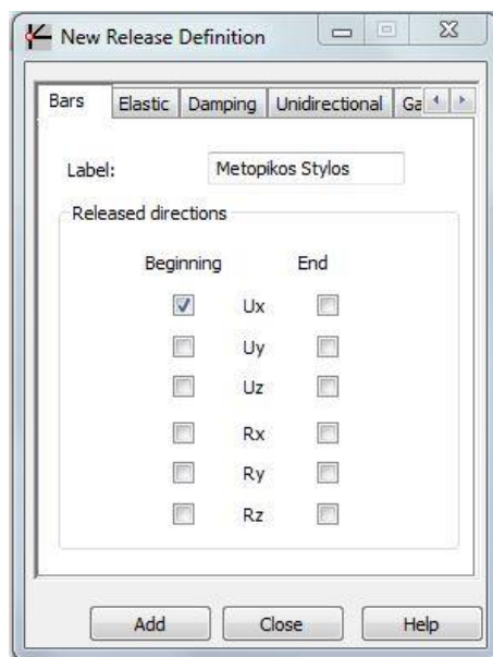
Εικόνα 5.10 Απελευθέρωση μετακινήσεων στην κορυφή των μετωπικών στύλων κατά τον άξονα X
