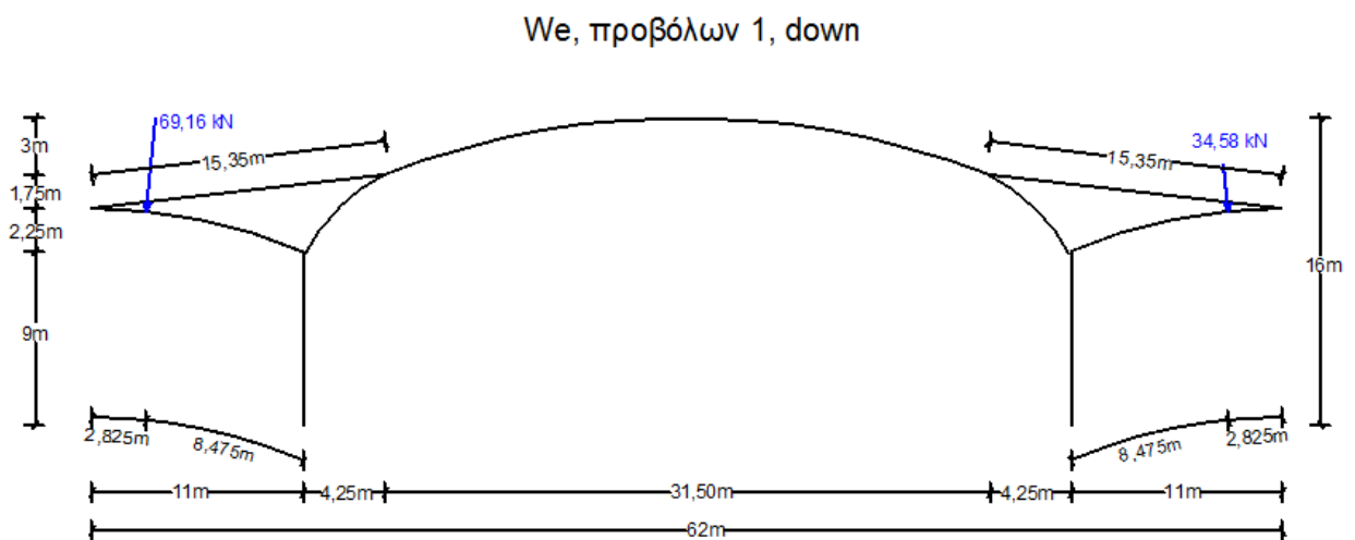
Σχήμα 3.14 Συγκεντρωμένα φορτία προβόλων ανέμου +X με φορά προς τα κάτω (Στέγαστρο 2)
