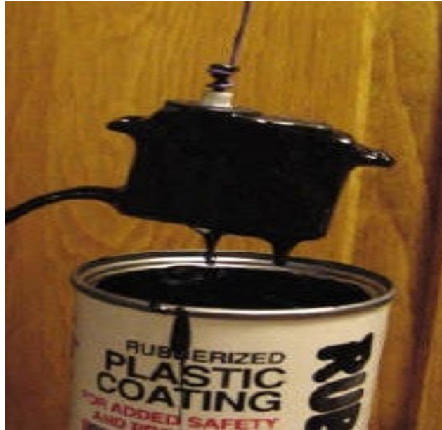
Εικόνα 3.4.2- Αδιαβροχοποίηση των ηλεκτρονικών μερών και του εξωτερικού κελύφους με υγρό καουτσούκ
