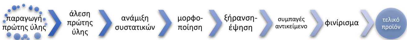
Σχήμα 1. Διάγραμμα ροής παραγωγής κεραμικών υλικών
